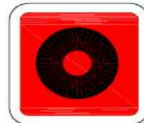
PULSADOR DE ALARMA
