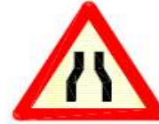
TP-17 ESTRECHAMIENTO DE CALZADA
