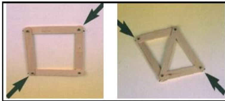
Figura 11: Triangulación con palos de madera, material de experimentación. Fuente: https://thales.cica.es/rd/Recursos/rd99/ed99-0053-02/contenido/estructuras.htm
