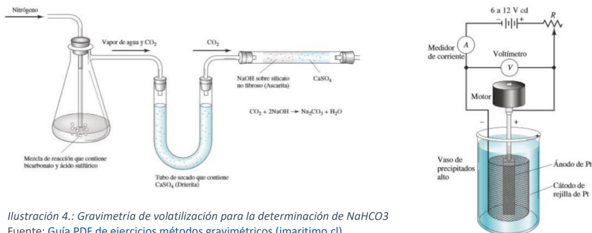
Ilustración 3. Celda para electrodeposición de metales Fuente: Guía PDF de ejercicios métodos gravimétricos (imaritimo.cl)
