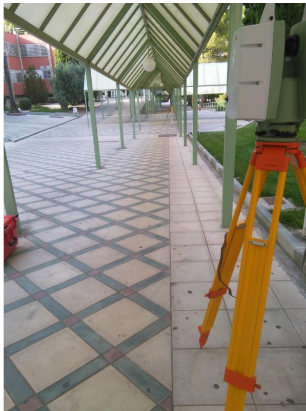
Imagen 19. Estación en base 6, escaneando diana en base 7.
