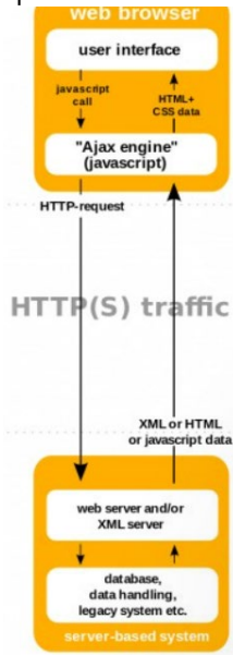
Ilustración 8.2 Diagrama de modelo de aplicación web con AJAX
