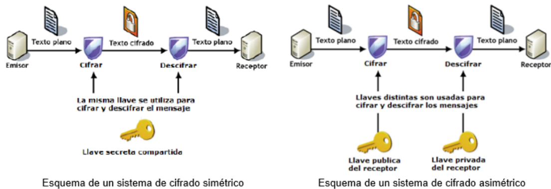
Ilustración 6.4 Esquemas generales de un sistema de cifrado simétrico y asimétrico
