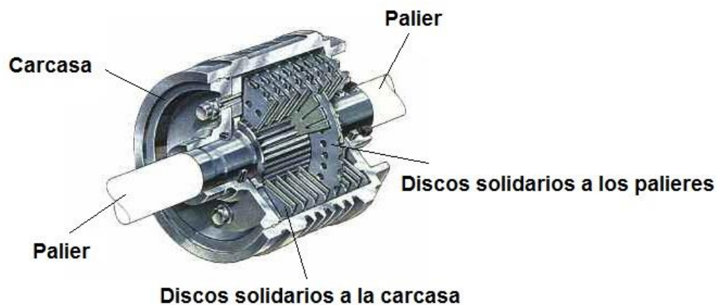
Imagen 1.2.7 – Mecanismo diferencial de deslizamiento limitado con acoplamiento viscoso [Fuente: adaptación de https://talleractual.com/ ]
