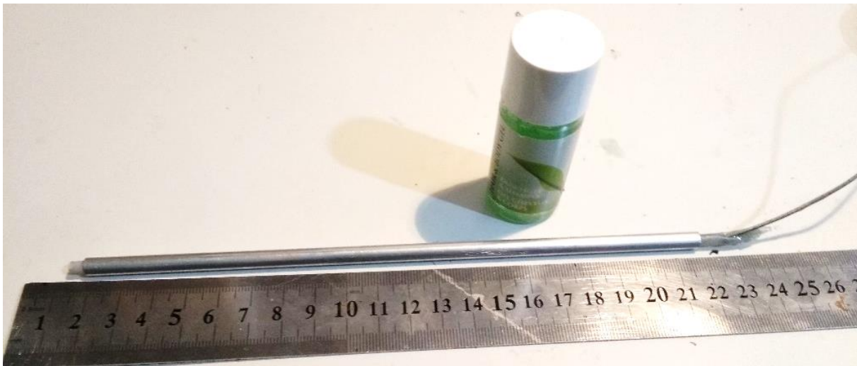
Figura 100. Proceso de inserción final de tubo de teflón en el interior de tubo de aluminio. Se realizó un acople provisional del primero a alambre para ser traccionado e introducido con lubricación.
