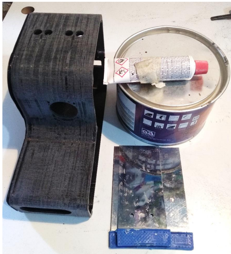
Figura 97. Proceso de enmasillado. La masilla empleada para polímeros es aplicada mediante espátula [81].
