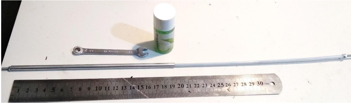
Figura 99. Proceso de inserción que somete el tubo de teflón a compresión. Basado en varilla roscada M3 y ser apretada por uno de los extremos. Resultó insatisfactorio.
