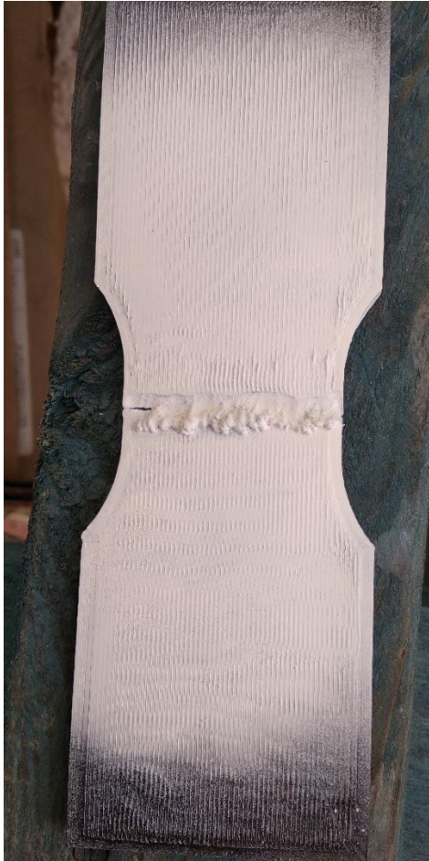
Figura 128. Proceso de pintado base blanca mate (izquierda) y rociado de speckle negro (derecha)
