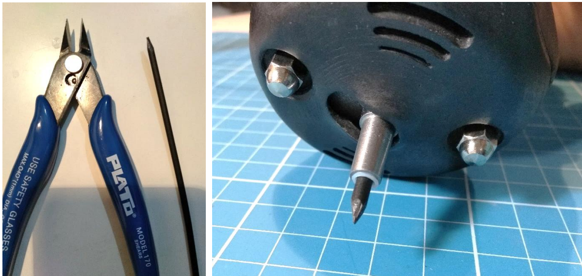
Figura 118. (Izquierda) afilado extremo de extremo. (Derecha) Filamento insertado en la herramienta.
