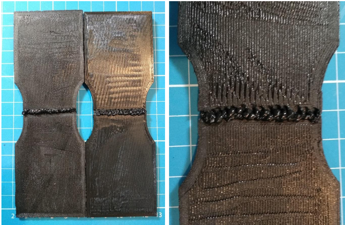
Figura 122. (Izquierda) Soldadura con falta de penetración y exceso de adición de material. (Centro, izquierda) soldadura siguiendo patrón de zig-zag a una alta velocidad (sentido de giro horario).
