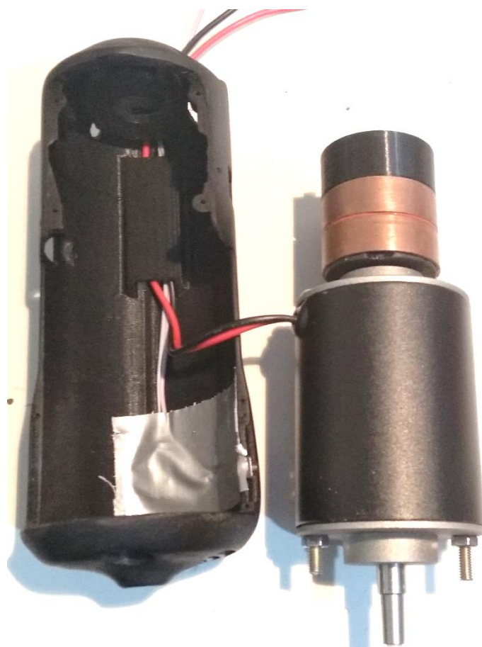
Figura 107. Inserción de cableado para montaje de motor.
