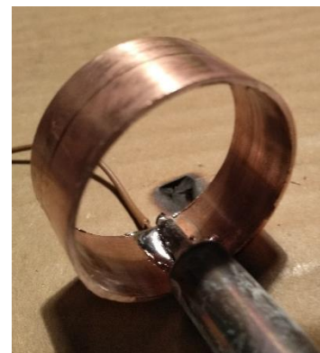
Figura 95. Proceso de soldeo de anillos rozantes.
