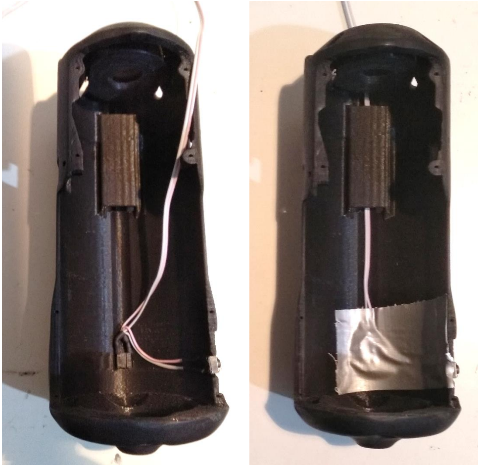
Figura 106. Montaje de pulsadores. La función de la cinta americana es solo facilitar el montaje, ya que los pulsadores se apoyarán en el propio motor.
