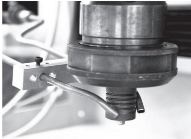
Figura 145. Sistema de distribución criogénico de CO 2 (Gabzdyl et al., 2001, Richards et al., 2008) [11].
