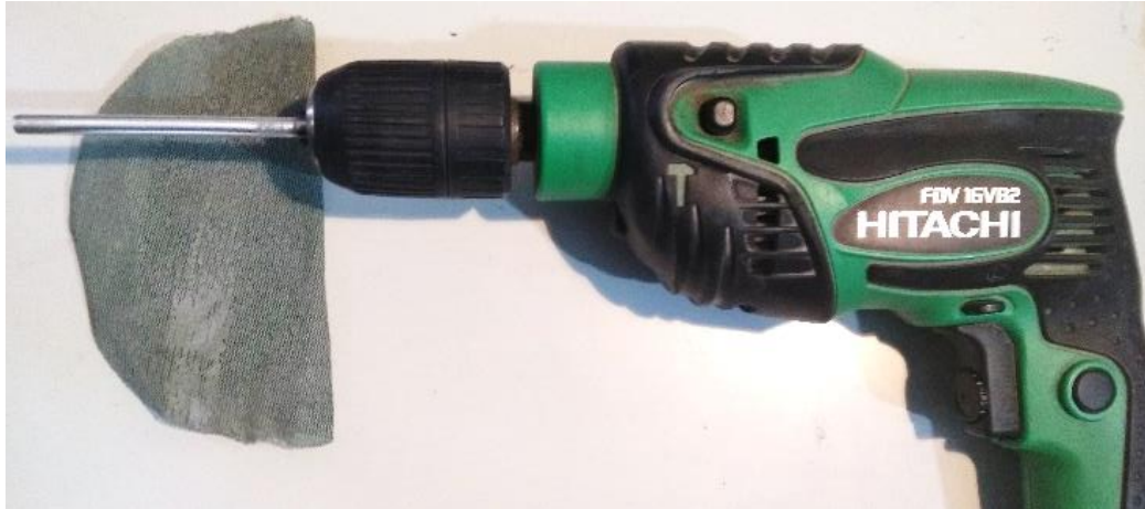
Figura 101. Lijado exterior tubo de aluminio [82].
