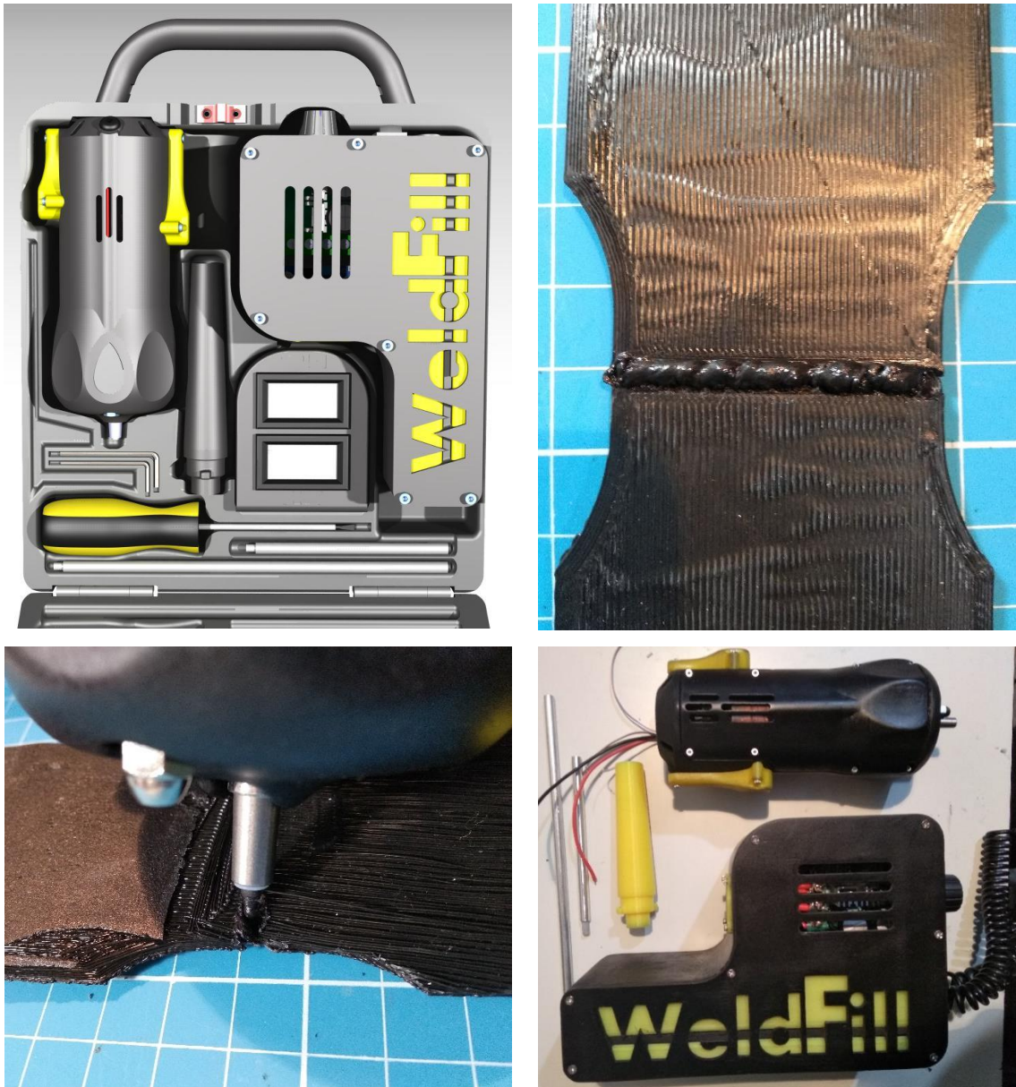
Figura 1. (Superior Izquierda) Modelo CAD sistema propuesto. (Superior Derecha) Herramienta fabricada. (Inferior Izquierda) Ensayo y testeo de prototipo de máquina herramienta. (Inferior Derecha) Soldadura obtenida con el método.
