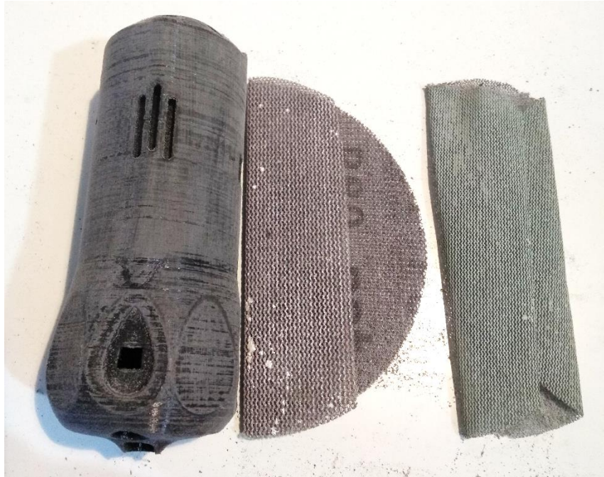
Figura 96. Proceso de lijado con distintos granos.
