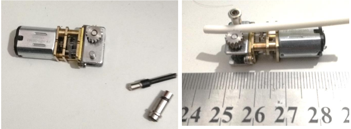
Figura 76. Versión inicial del contra apoyo de filamento, (izquierda) construcción. (Derecha) testeo en filamento de 3 mm.
