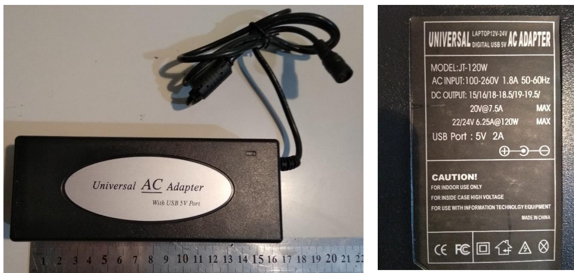
Figura 47. Transformador con salida 5 A, 24 V y placa de características.
