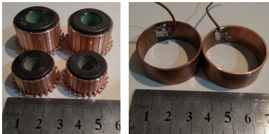
Figura 57. (Izquierda) Colectores de delgas de multi-herramientas (opción rechazada). (Derecha) Solución final adoptada, anillos rozantes cortados a partir de tubo de cobre de diámetro interior 33 mm.
