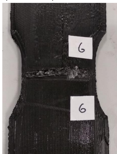
Figura 141. Soldadura deficiente realizada con ABS blanco.
