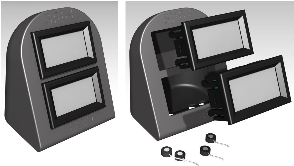
Figura 74. Alojamiento para los dos voltímetros y 4 conectores magnéticos.
