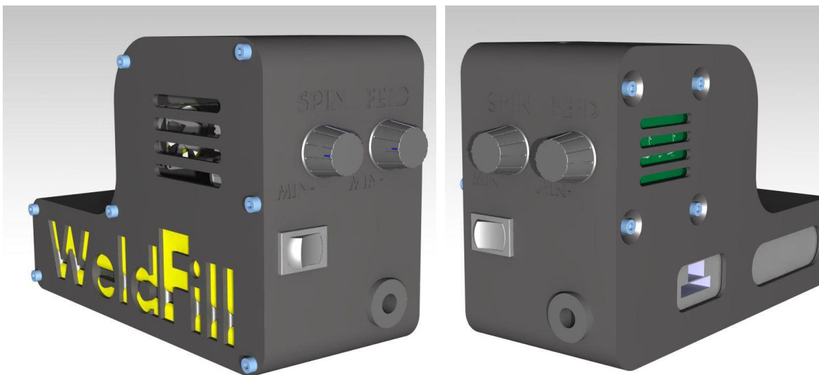
Figura 73. Solución final llevada a cabo para la caja auxiliar. En esta versión además de cumplir la funcionalidad, se ha integrado el transformador para minimizar el número de componentes visibles.
