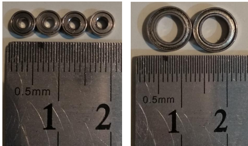
Figura 58. (Izquierda) rodamientos usados en el contra apoyo. (Derecha) rodamientos usados en sistema de guiado.
