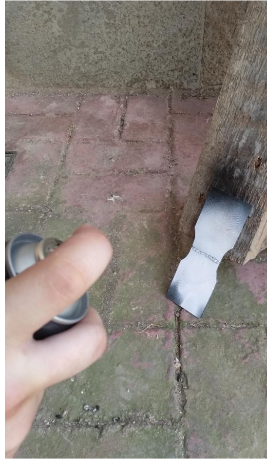
Figura 128. Proceso de pintado base blanca mate (izquierda) y rociado de speckle negro (derecha)
