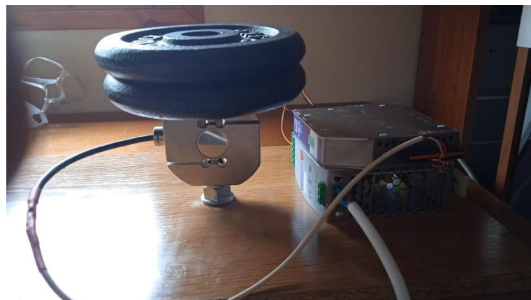
Figura 33: Montaje calibración célula de carga
