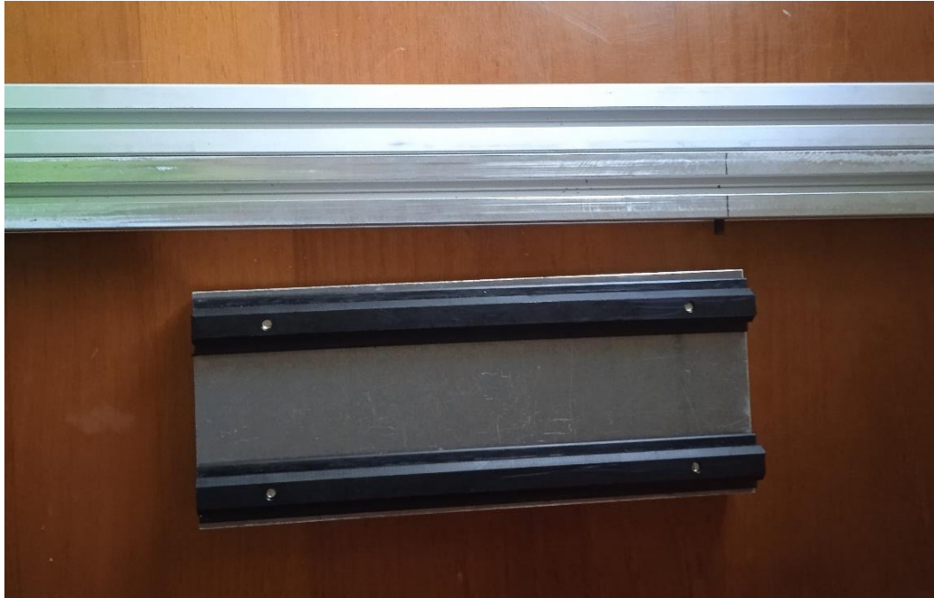
Figura 3: Perfil Bosch y deslizaderas
