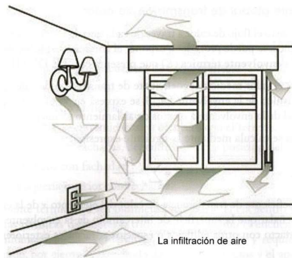
Ilustración 7. Infiltraciones de aire en elementos constructivos
