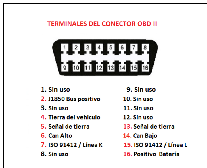
Ilustración 19 – Conector OBD y sus pines de conexión
