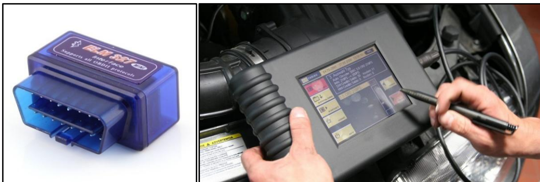
Ilustración 20 – Dispositivos de diagnosis, a la izquierda el utilizado en este proyecto. A la derecha dispositivo utilizado en talleres mecánicos
