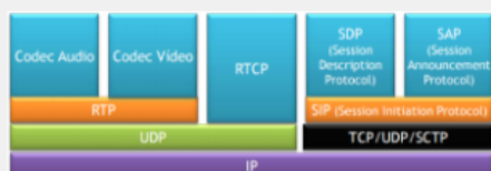
Figura 1. Torre de protocolos
