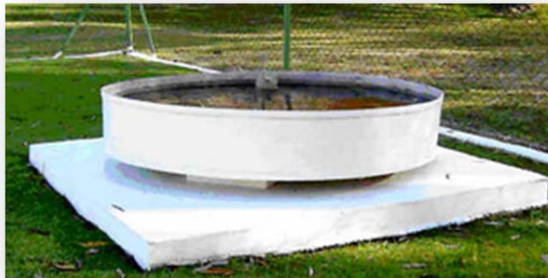
Fig. 21. Tanque de evaporación
