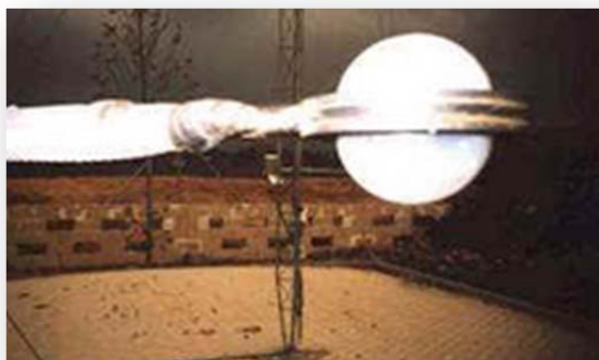
Fig. 37. Cúpula de silicona de un radiómetro de radiación neta.
