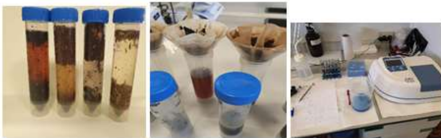
Figura 3.7 Fotografías de los extractos de las muestras, su filtrado, y medida final en espectrofotómetro.
