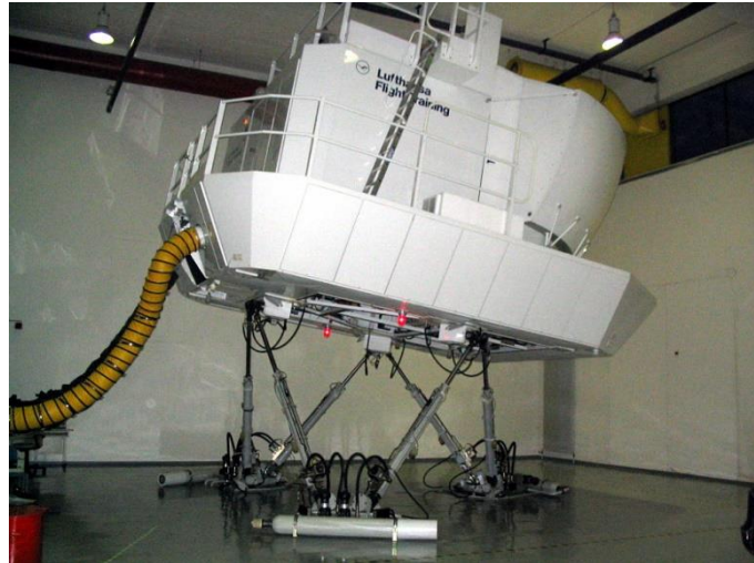
Figura 1.2.7. Simulador de vuelo de Lufthansa sustentado por una plataforma Stewart [9].
