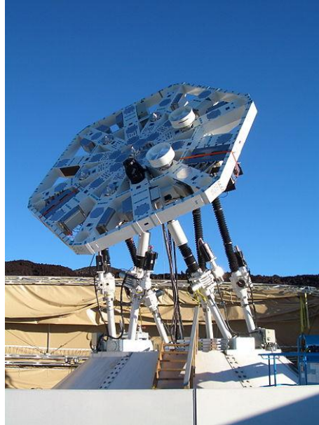
Figura 1.2.9. Telescopio AMiBA situado en Hawaii durante su construcción en 2006 montado sobre una plataforma Stewart [11].
