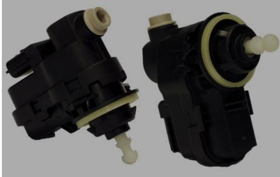
Figura 11. Motor eléctrico con acceso manual de regulación de faro. [25]
