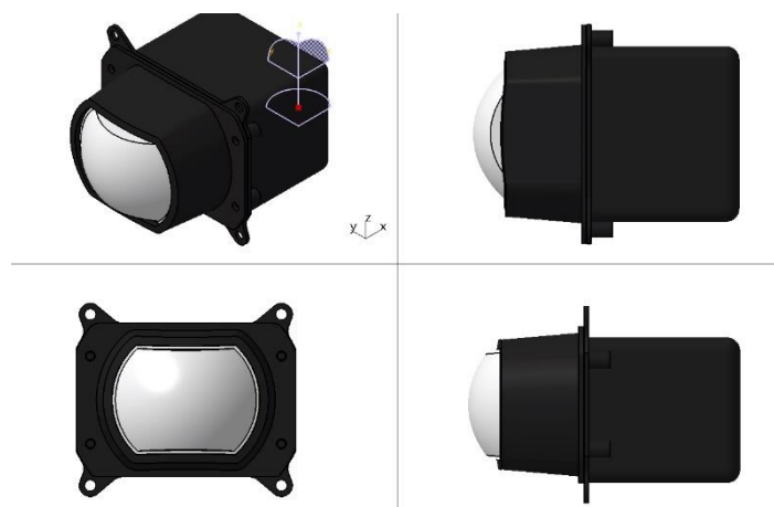
Figura 20. Módulo Bi-LED diseñado. [Elaboración Propia]
