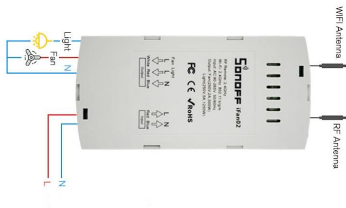
Ilustración 24: Sonoff iFan02 (Diagrama de conexión)
