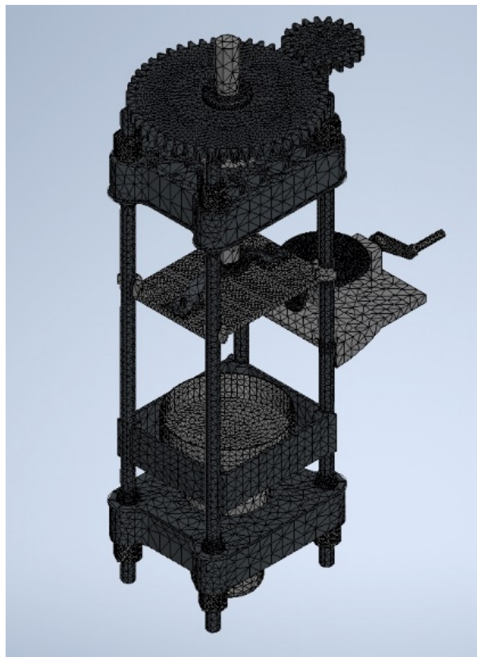
Ilustración 131. Mallado del ensamblaje.
