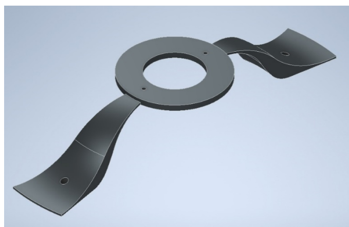
Ilustración 46. Perspectiva axonométrica de la placa de refuerzo.
