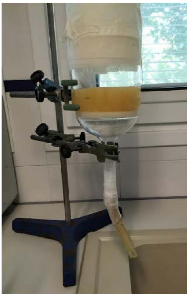
Imagen 6. Purificación de la bacteriocina mediante la cromatografía de intercambio iónico con la matriz CM Sephadex C-25
