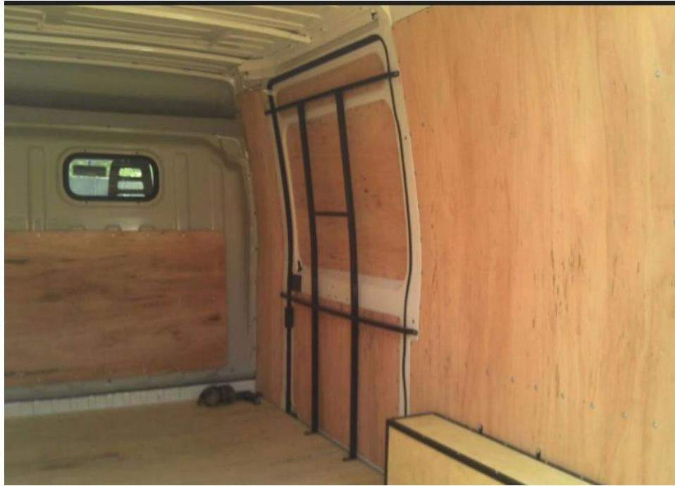
Ilustración 13. Panelado interior de contrachapado.
