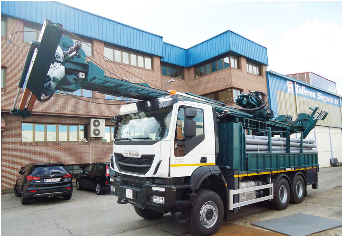
Figura 1.17. Perforadora Segoquei 21 en camión IVECO
