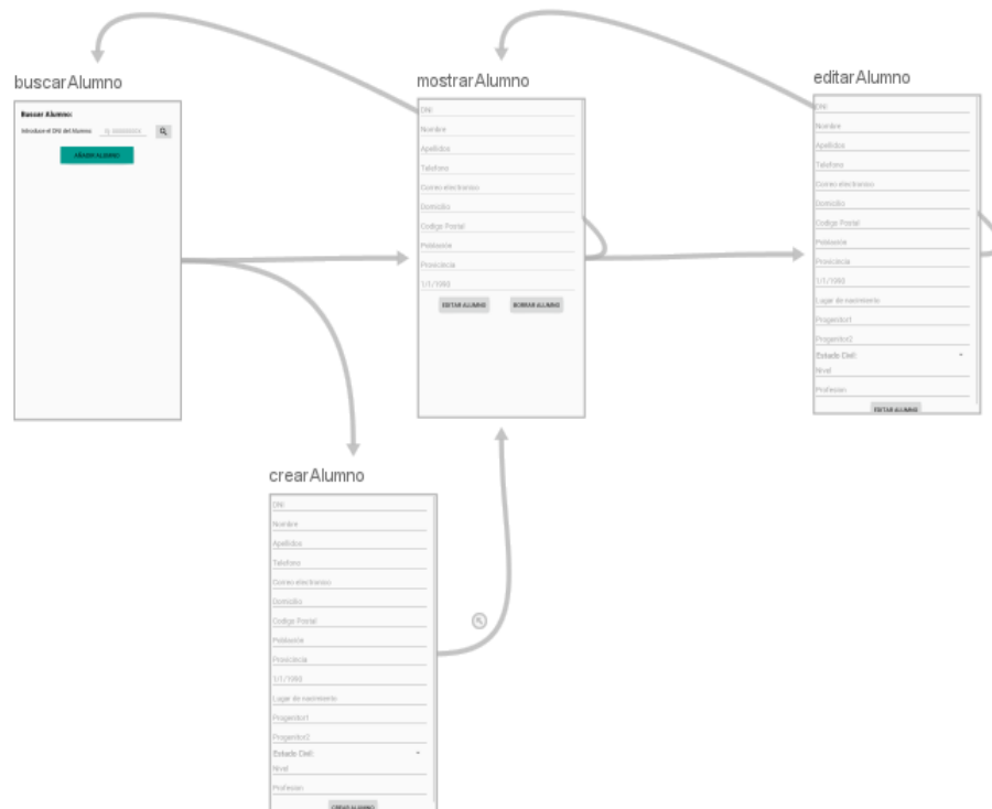
Figura 14: Grafo Navegación – Iteración 1, Cliente Móvil
