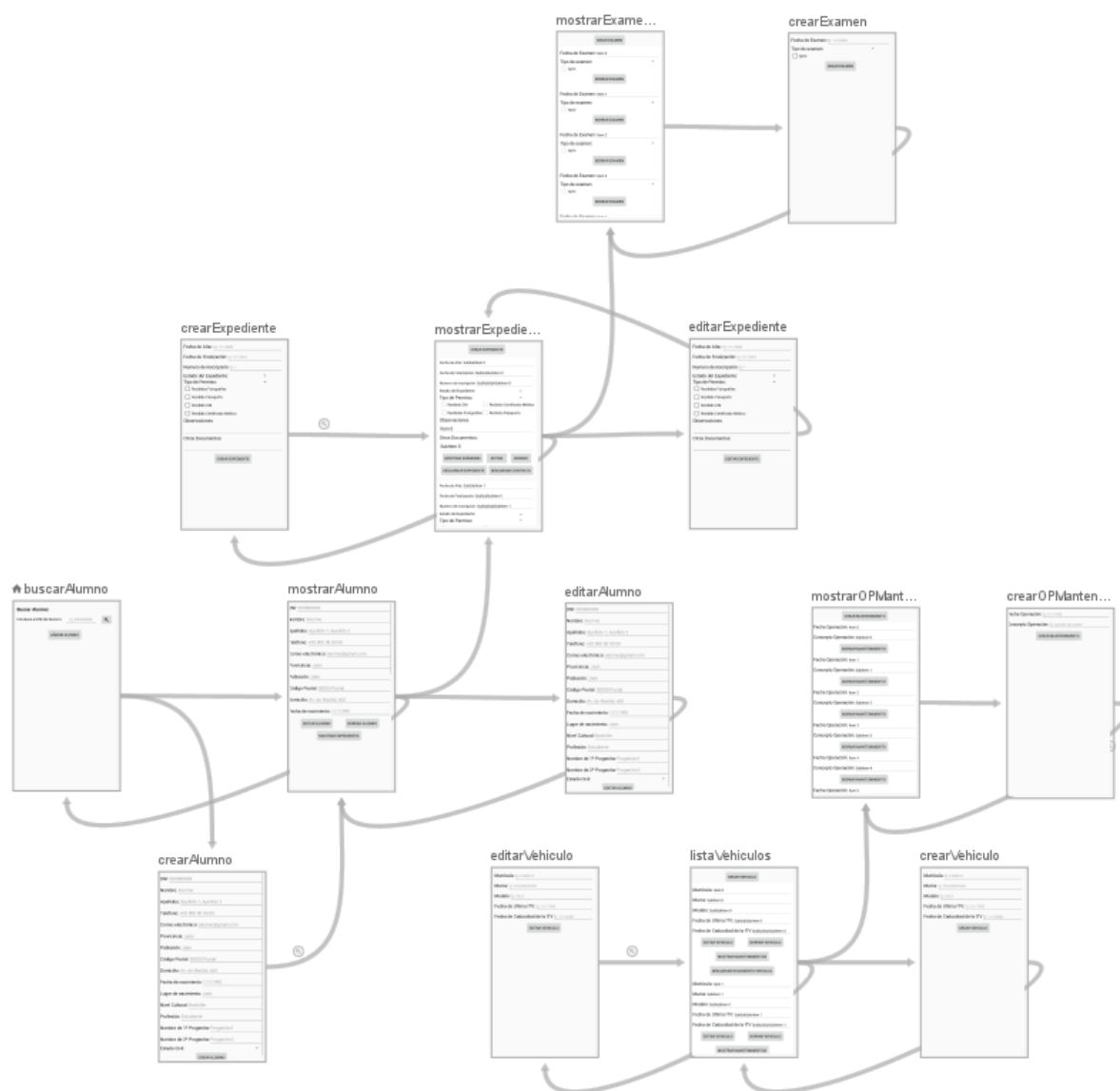
Figura 71: Grafo de Navegación – Iteración 5, Cliente Móvil
