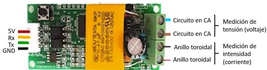
Figura 21: Esquema de conexiones del PZEM 004T
