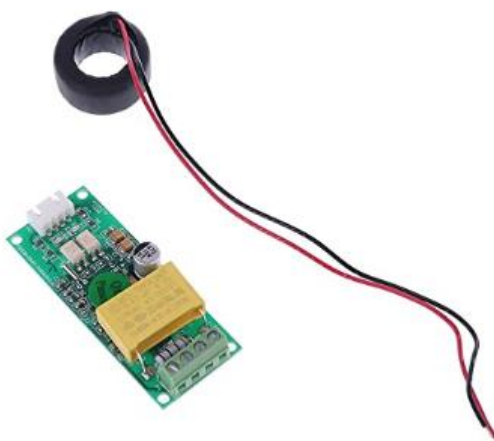
Figura 20: Medidor PZEM-004T con anillo toroidal cerrado
