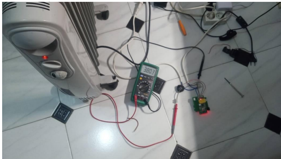
Figura 68: Dispositivo y multímetro conectados a un radiador eléctrico
