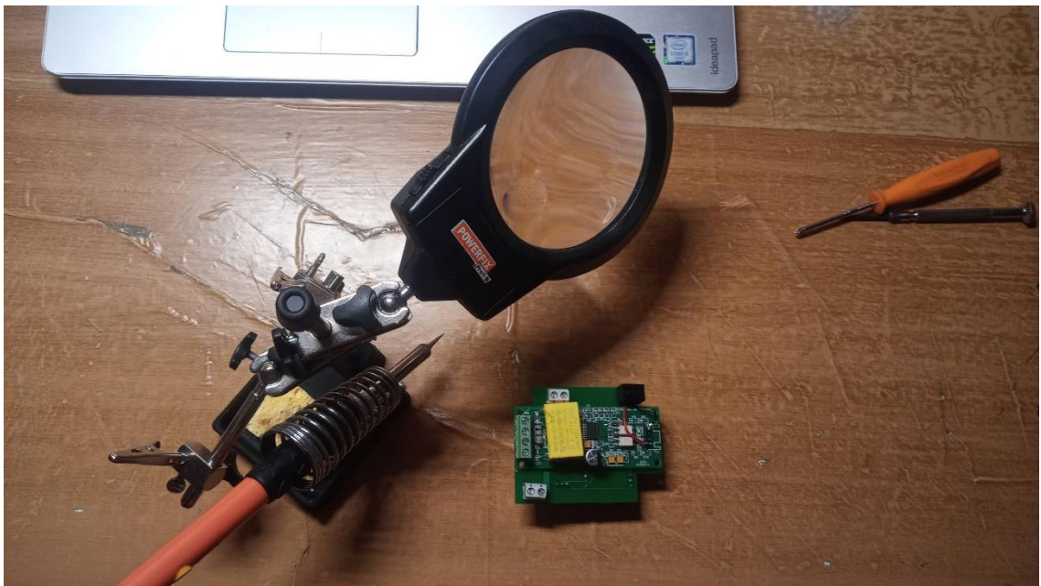
Figura 65: Soldadura del prototipo
