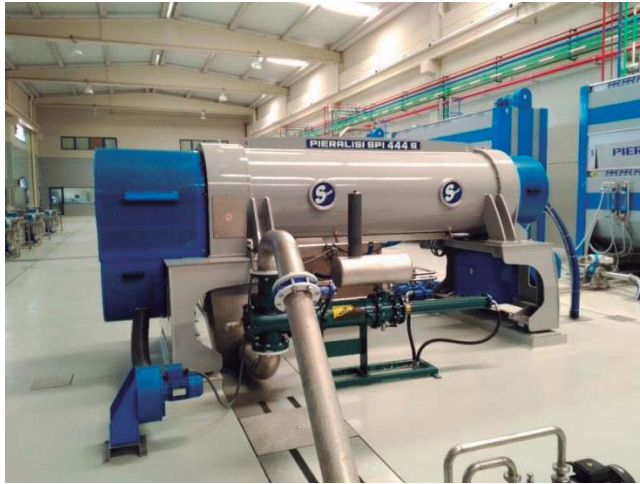
Ilustración 22: Batidora horizontal en las instalaciones de Picualia. Fotografía del autor.
