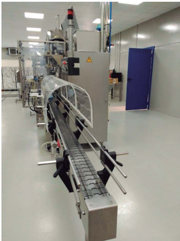
Ilustración 34: Zona de posicionado en la envasadora en Picualia . Fotografía del autor.
