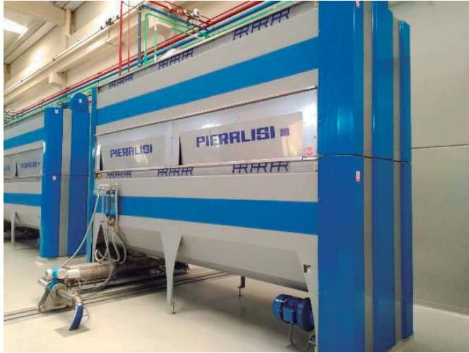
Ilustración 19: Molinos en la almazara Picualia. Fotografía del autor.
