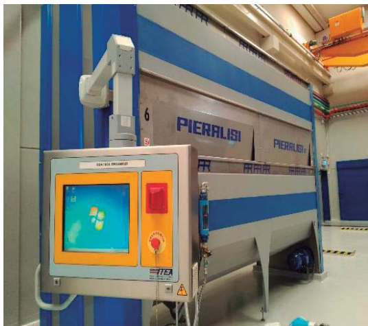
Ilustración 20 : sistema informático de control de los molinos. Fotografía del autor.
