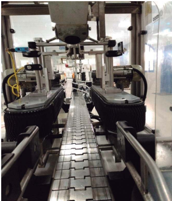
Ilustración 36: Zona de cerrado de la envasadora. Fotografía del autor.
