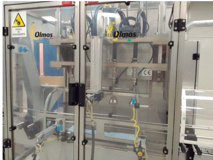
Ilustración 35: Zona de llenado de la envasadora. Fotografía del autor.
