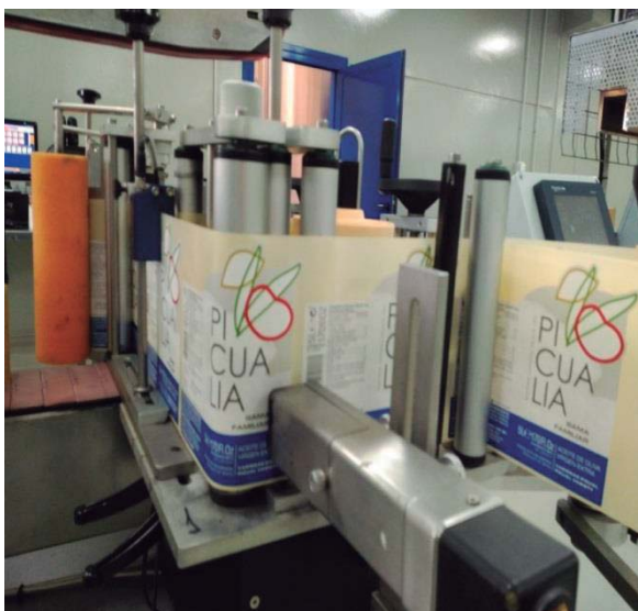
Ilustración 38: Etiquetado de los envases de 5l en Picualia. Fotografía del autor.
