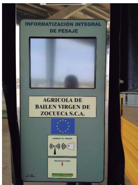
Ilustración 16: Sistema informatizado de identificación del proveedor y de la partida de aceituna. Fotografía del autor.
