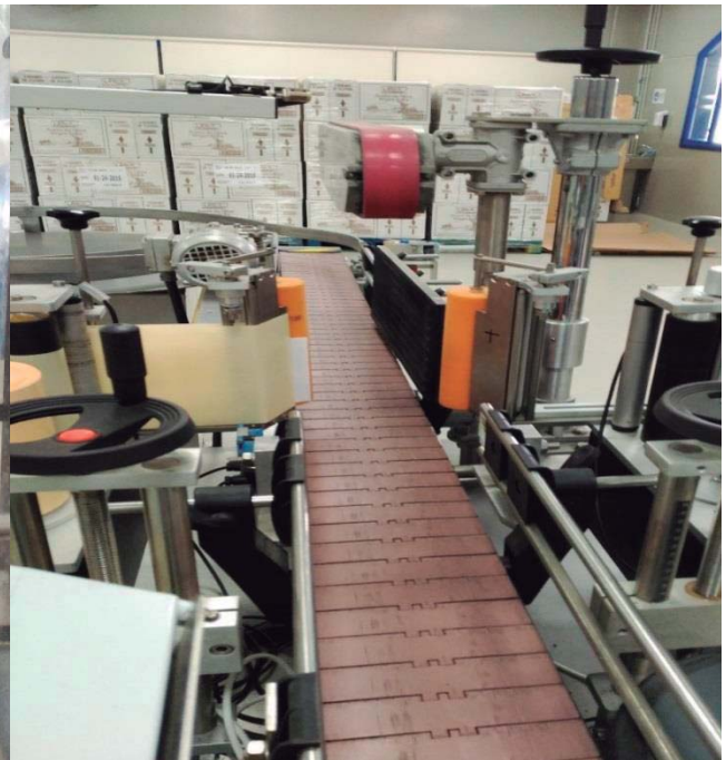
Ilustración 37: Zona de etiquetado de la envasadora. Fotografía del autor.
