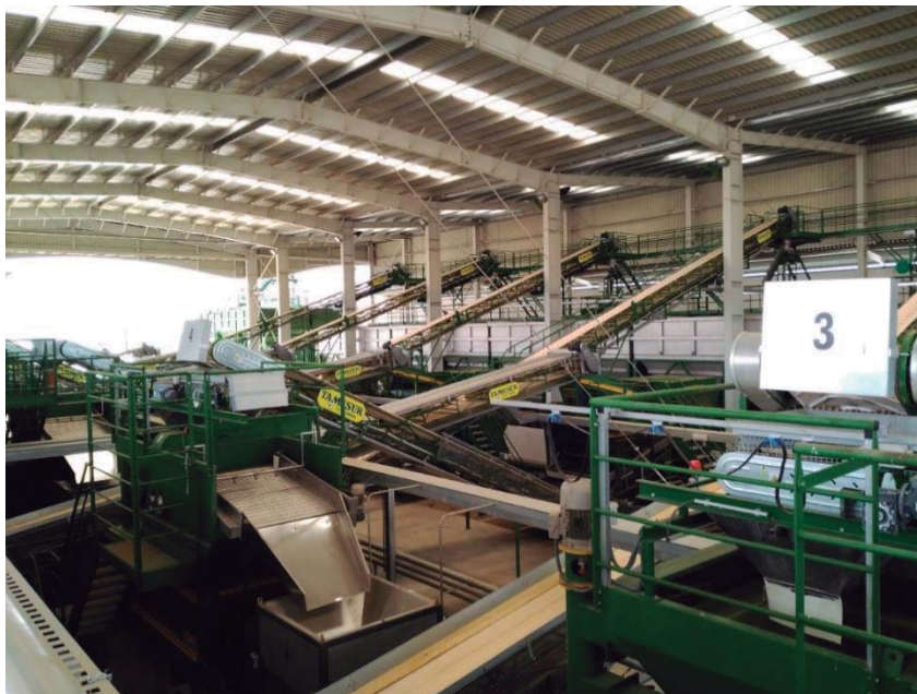
Ilustración 17: Cintas transportadoras de la zona exterior, donde se realizan los procesos de limpieza de la aceituna. Fotografía del autor.
