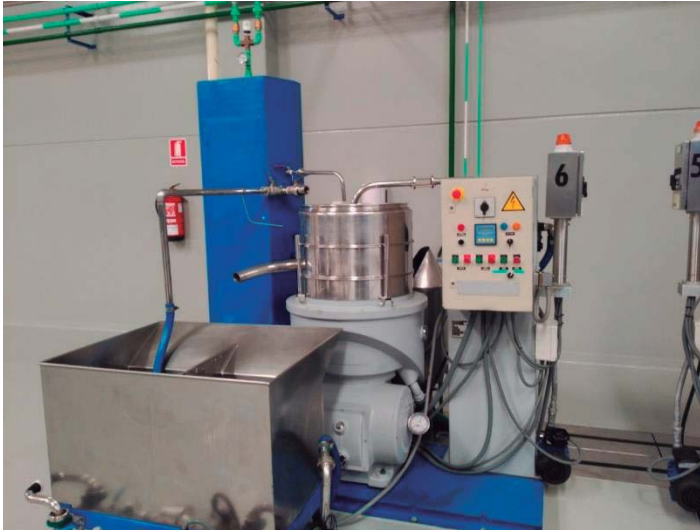
Ilustración 23: Centrifugadora vertical en las instalaciones de Picualia. Fotografía del autor.
