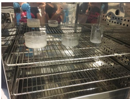
Imagen 16: Determinación de la humedad presente en los polímeros
