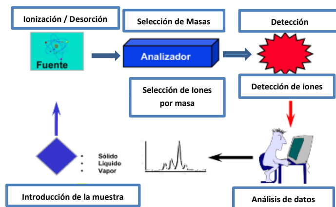
Figura 11: Esquema del proceso del análisis por espectrometría de masas. [33]
