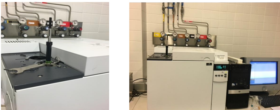
Imagen 13: Inyección de la jeringa de SPME en el cromatógrafo de gases.
