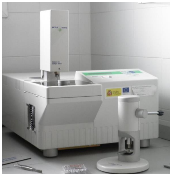
Imagen 15: Calorímetro diferencial empleado
