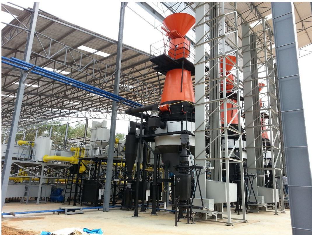
Imagen 10. Gasificador de ANKUR. Tipo Downdraft. Fuente BIOLIZA
