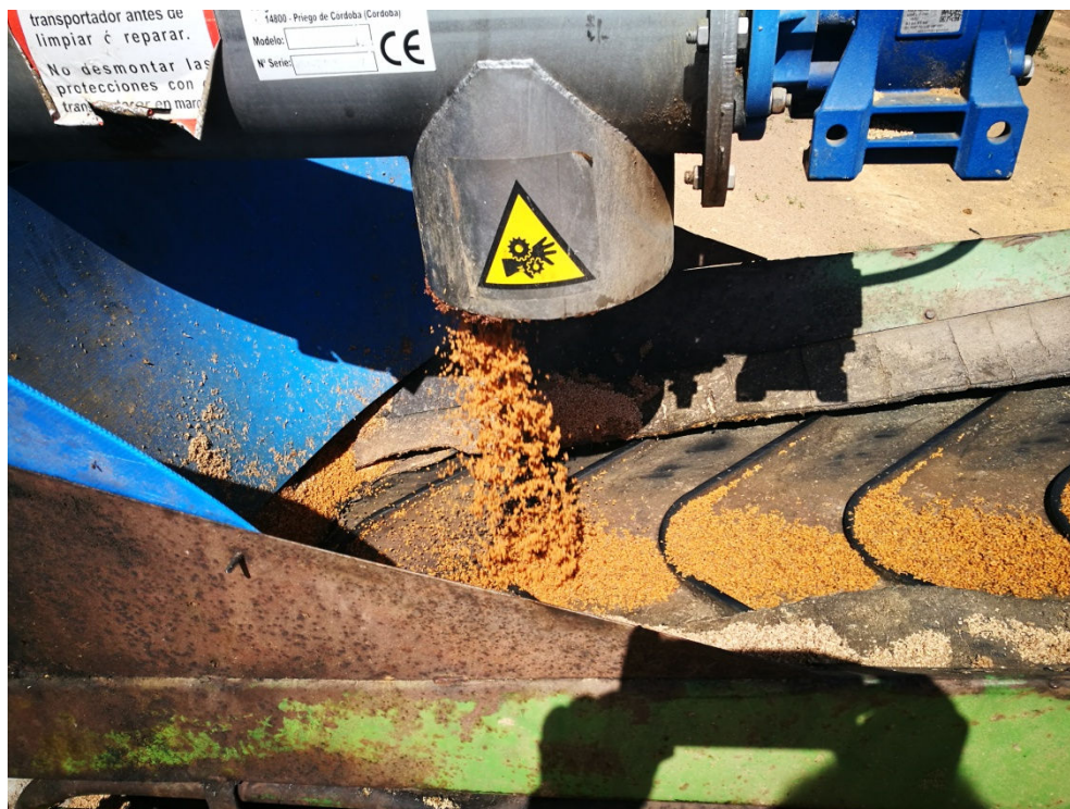
Imagen 5. Detalle del equipo separador de hueso. Fuente BIOLIZA.
