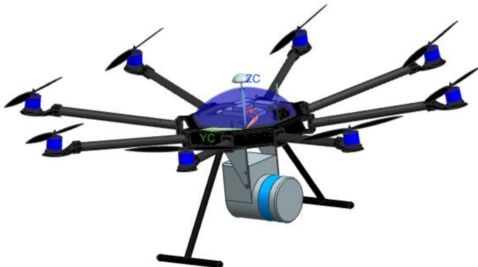
Ilustración 51: UAV con LIDAR y tren de aterrizaje en posición 1
