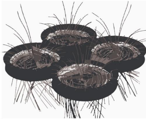
Ilustración 6: simulación del aire en un UAV
