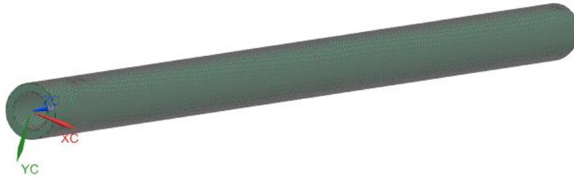
Ilustración 40: Brazo1 Mallado de 2 mm
