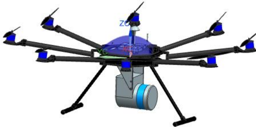
Ilustración 52: UAV con LIDAR y tren de aterrizaje en posición 2
