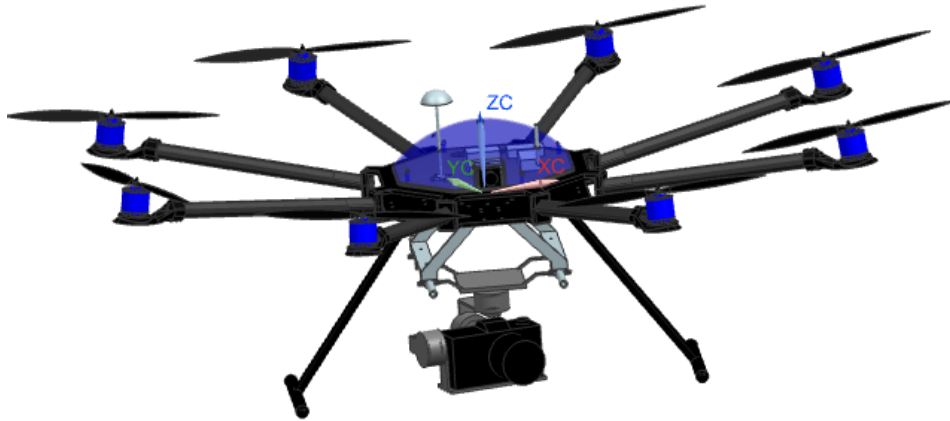
Ilustración 57: UAV con cardan, estabilizador y cámara
