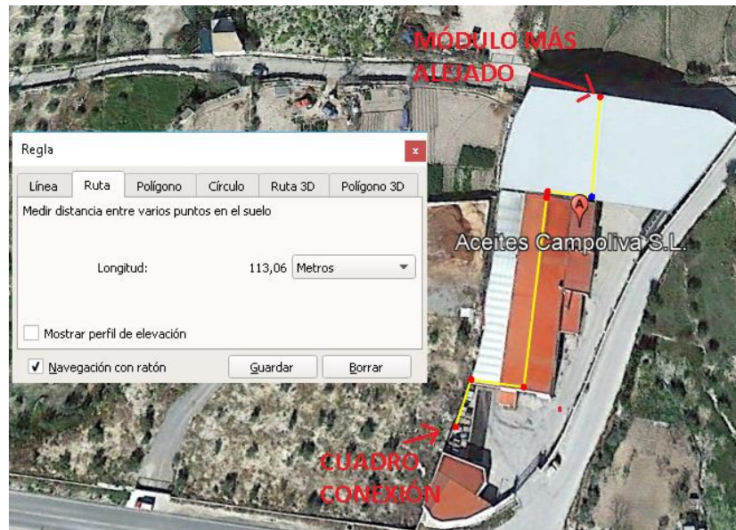
Ilustración 33. Distancia entre cuadro de conexión y módulo más alejado.
