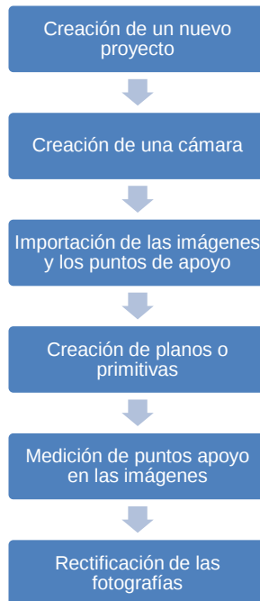
Figura 3-52. Flujo de trabajo con fotoarq3D
