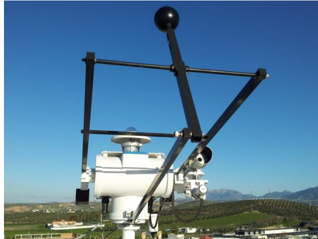
Figura 8. Pirheliómetro de la marca Delta-Ohmn Lp Pyrhe 16 montado sobre un seguidor solar de la marca EKO modelo Sun Tracker STR 22G.
