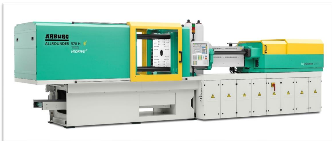
Imagen 1: Inyectora de plástico (Arburg Allrounder 570H) [1]
