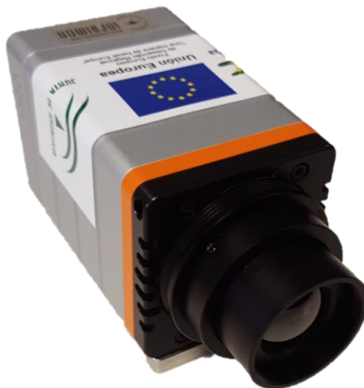
Figura 3.8 Cámara térmica Gobi-640-GigE
