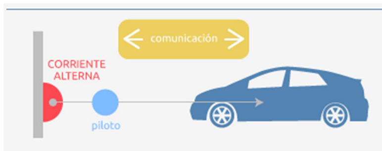
Ilustración 51: Modo 2 de recarga
