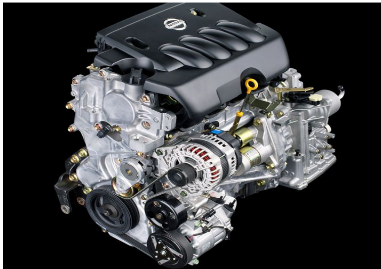
Ilustración 29: Motor de gasolina de 1600 cm 3
