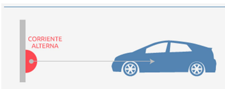
Ilustración 50: Modo 1 de recarga
