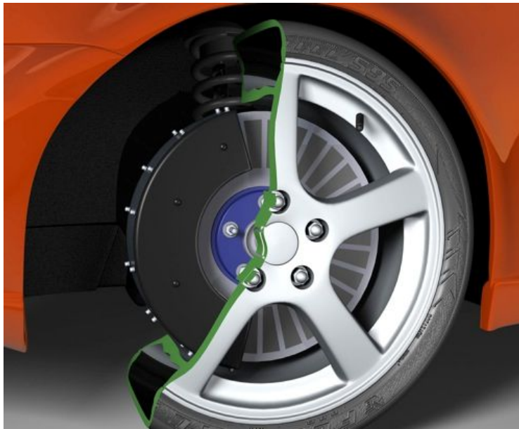
Ilustración 41: Ejemplo de aplicación de motor de flujo axial
