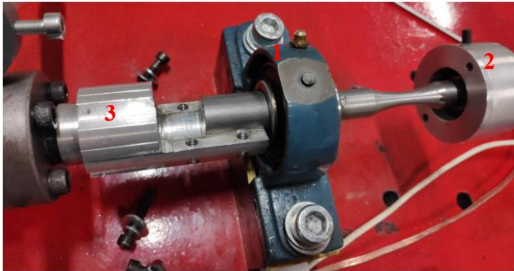
Figura 35: Conexión de la probeta con el motor eléctrico.
