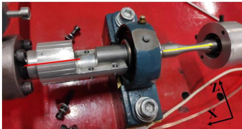
Figura 37: Alineación del eje del motor con la probeta con respecto al plano XZ
