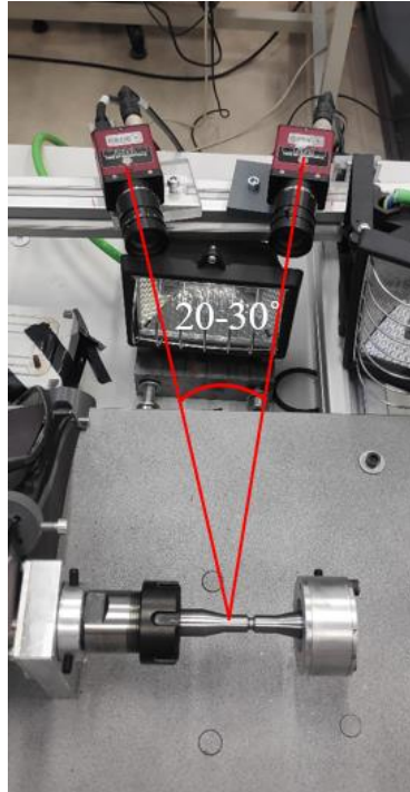
Figura 94: Representación del ángulo entre las dos cámaras
