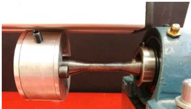
Figura 33: Probeta colocada en voladizo en la configuración original [26]
