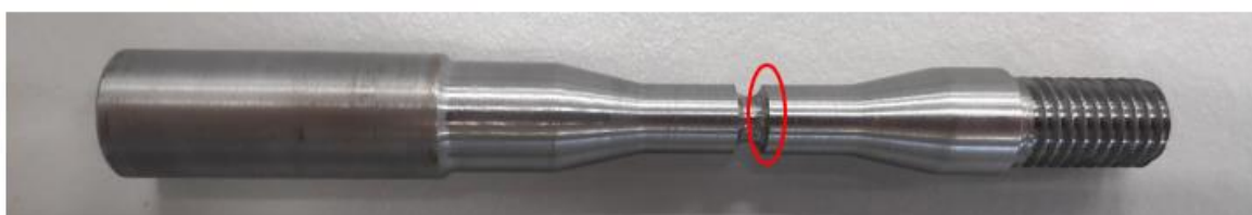
Figura 107: Probeta de planos paralelos con entalla con zona exterior de la entalla remarcada
