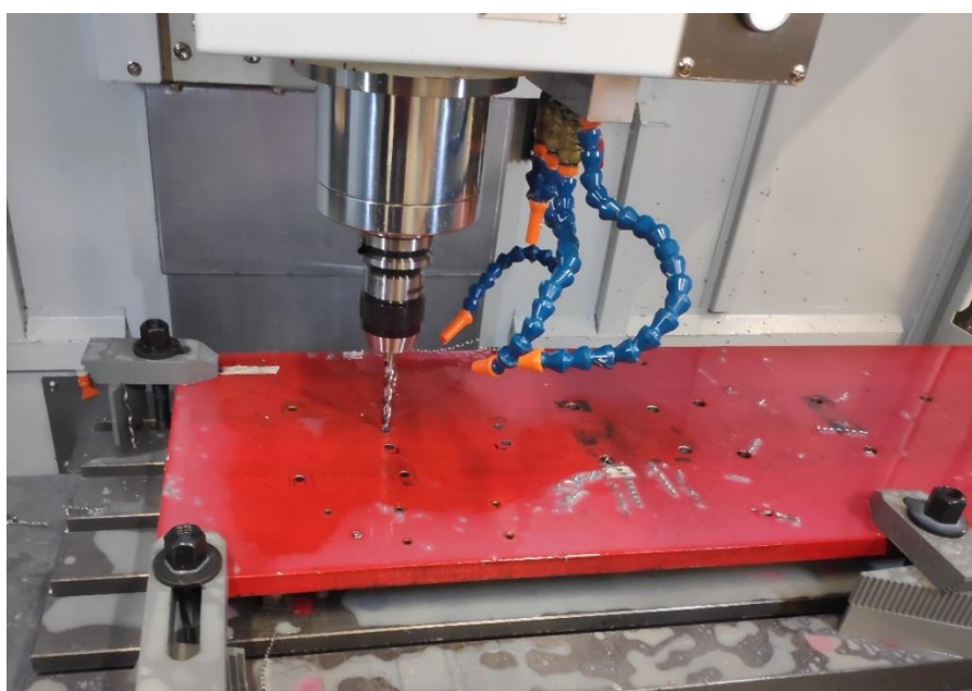
Figura 42: Realización de los agujeros en la plancha de acero en el taller de mecánica.
