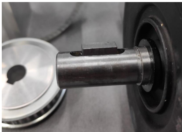
Figura 39: Ranura del eje del motor junto con la chaveta y polea con el chavetero.
