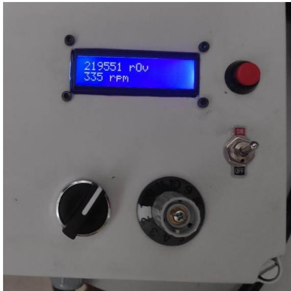
Figura 63: Funcionamiento del contador de revoluciones (dato superior) y medida de la velocidad de la probeta (dato inferior).
