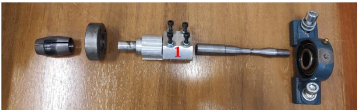
Figura 34: Abrazadera atornillada (Marca 1) original que sujetaba el eje del motor y la probeta
