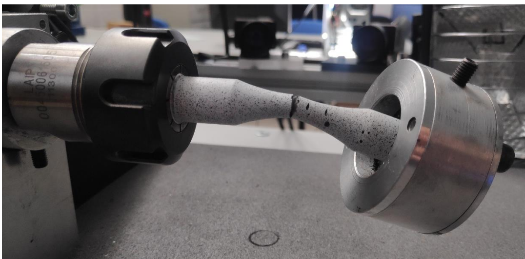
Figura 102: Rotura parcial de la probeta de reloj de arena con una carga de 28 kg
