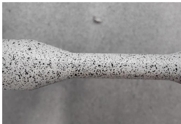
Figura 27: Probeta con base de pintura blanca junto con un posterior moteado aleatorio de color negro
