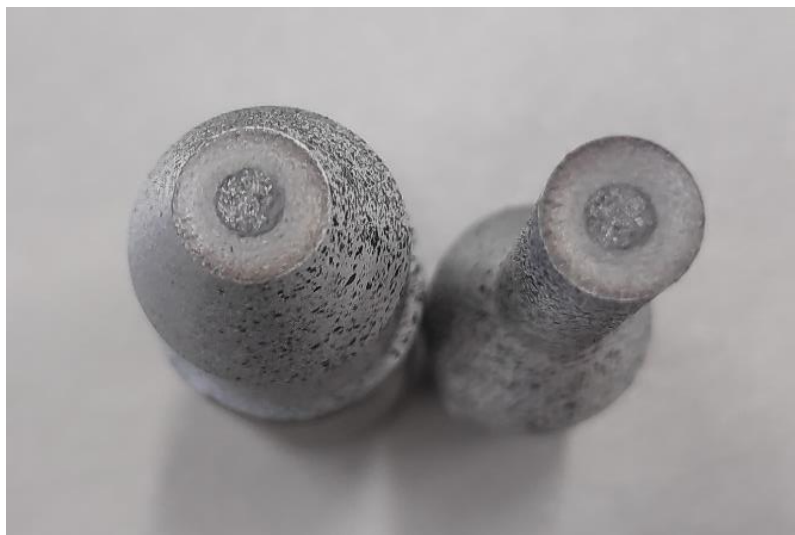
Figura 100: Frente de grieta obtenido para la probeta de planos paralelos con una carga de 28 kg
