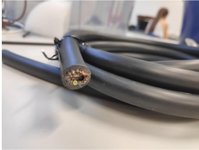
Figura 50: Manguera utilizada para la distribución de cables
