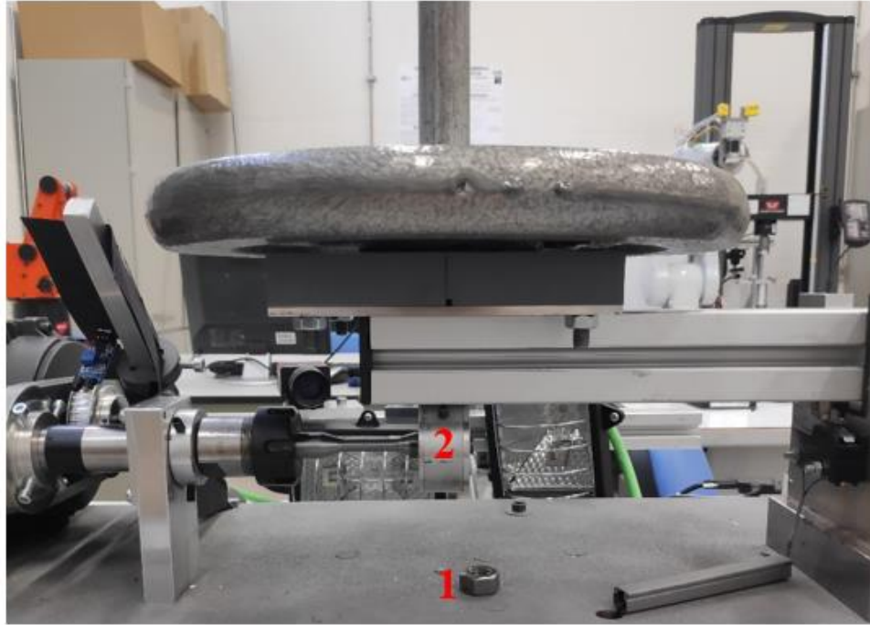
Figura 45: Tornillo (Marca 1) y rodamiento en el que va apoyado el brazo para las pesas (Marca 2)
