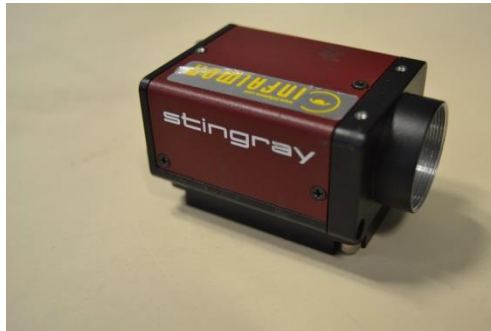
Figura 69: Cámara Stingray F080C de alta definición y zoom de 75 mm empleado para los ensayos
