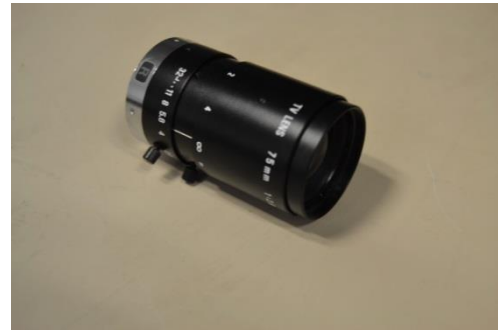
Figura 69: Cámara Stingray F080C de alta definición y zoom de 75 mm empleado para los ensayos
