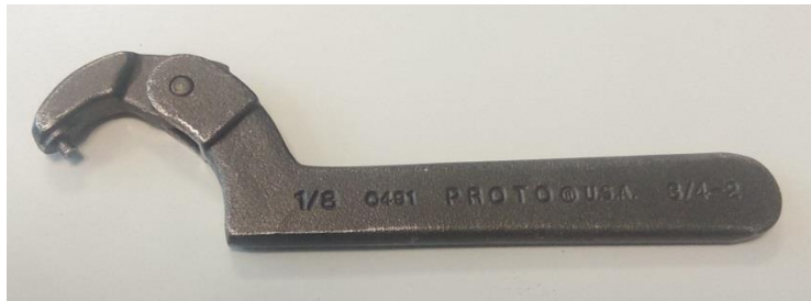
Figura 74: Llave empleada para la manipulación (apriete y desapriete) de las mordazas
