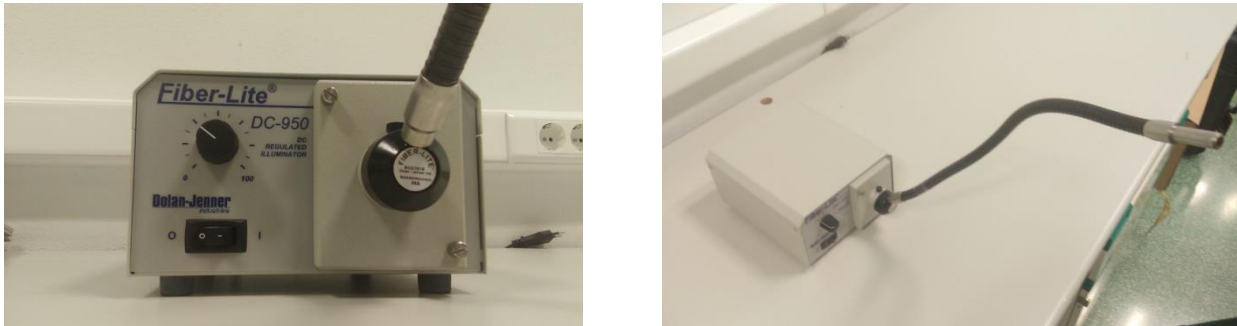
Figura 106: Fuente de luz regulable con emisión por fibra óptica
