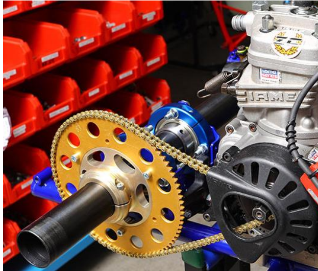
Figura 14. Sistema de transmisión formado por motor-corona-eje trasero-cadena
