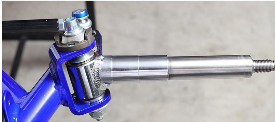
Figura 12. Ajuste del ángulo de caída en la mangueta
