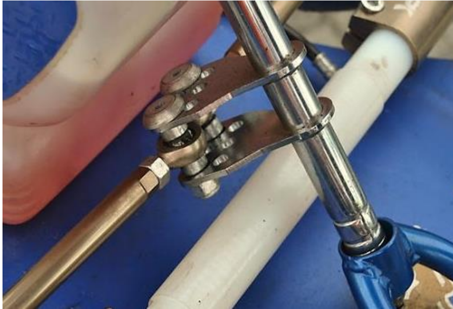
Figura 10. Ajuste de convergencia o divergencia
