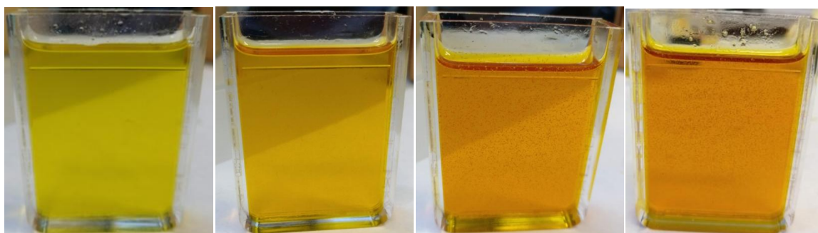
Figura 17. Progresión de cubetas con aceite de oliva virgen extra Hojiblanca; sin antioxidante, con 100, 200 y 365 ul, respectivamente de antioxidante; [\beta\text{-Caroteno}] = 3.27 \text{ mg/mL} .
