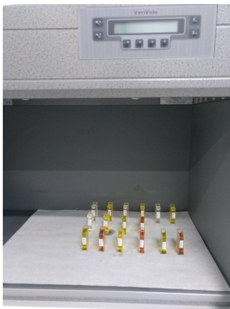
Figura 11. Cubetas de aceite de girasol y aceite de oliva en el interior de la cabina de luz UV.
