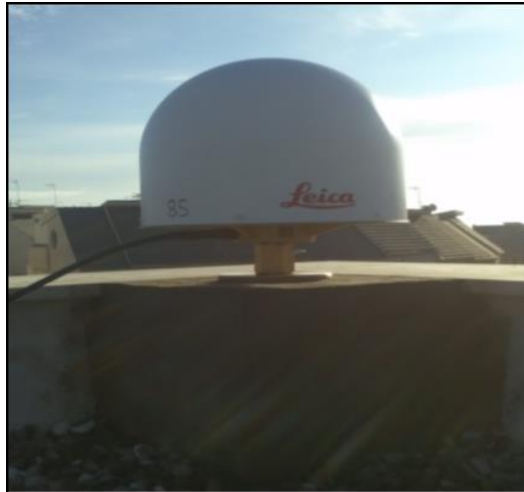
Figura 6: Antena GNSS de la estación permanente de Melilla.
