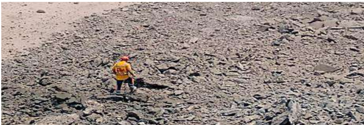
Figura 3.18 — Reconocimiento de la voladura detonada.
