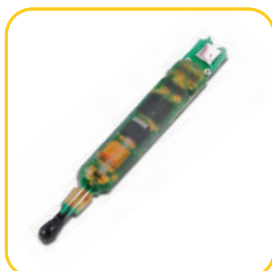
Módulo de retardo integrado revestido de resina resistente a la presión.
