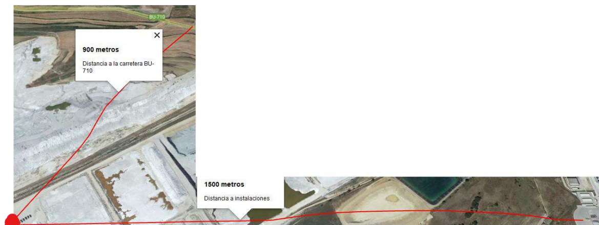
Figura 7.8.— Distancia a elementos implicados en la voladura.
