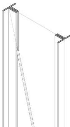
Figura 3.8 Detalle de colocación de perfiles en L de las cerchas de fachada. Fuente: Elaboración propia
