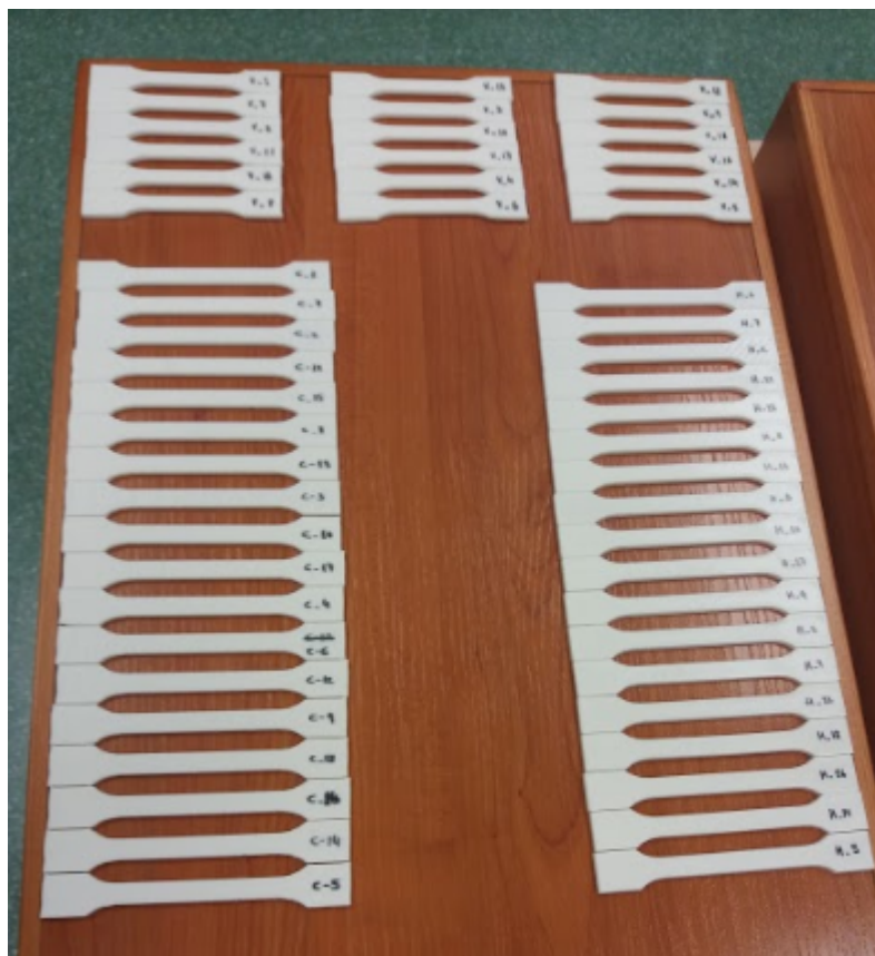
Figura 4.19. Probetas de PLA virgen impresas en las tres direcciones para el experimento 2.
