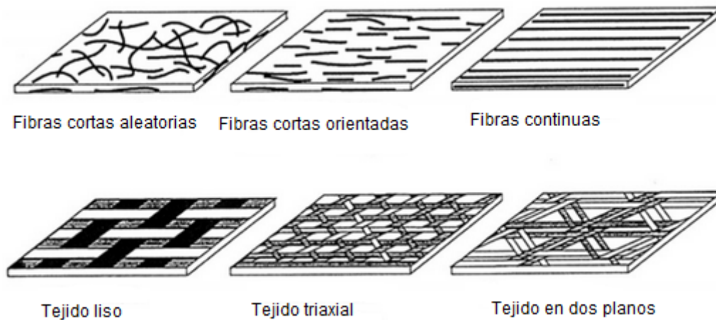
Figura 2.8. Algunas configuraciones de refuerzos en forma de fibra (Haghshenas, 2016).
