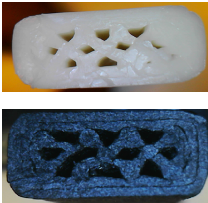
Figura 4.24. Sección de rotura de probeta vertical g_10. Arriba PLA virgen y abajo PLA reforzado.
