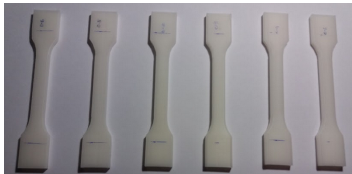
Figura 4.13. Probetas de PLA virgen impresas en dirección vertical (experimento 1).
