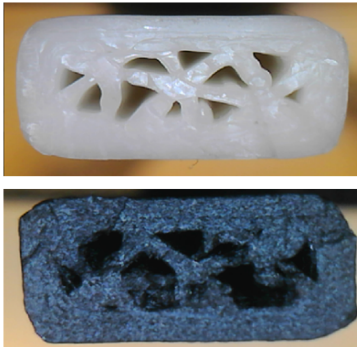
Figura 4.26. Sección de rotura de probeta vertical g_12. Arriba PLA virgen y abajo PLA reforzado.
