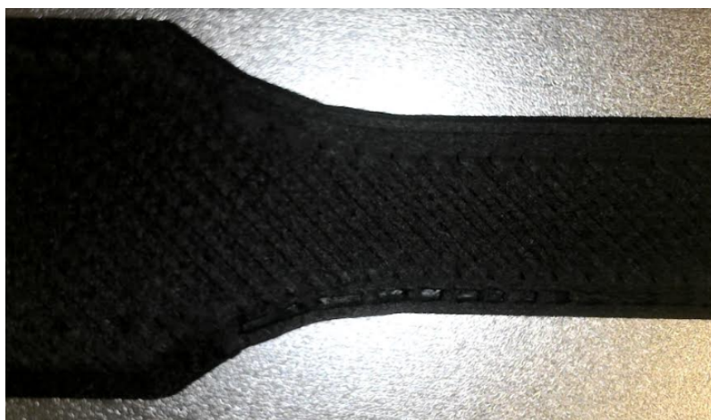
Figura 0.4. Falta de material en la zona de curvatura en probetas horizontales (PLA reforzado).
