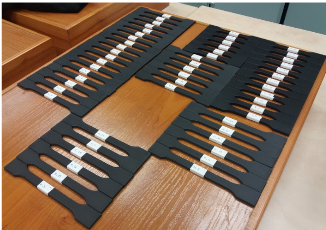
Figura 4.20. Probetas de PLA reforzado impresas en las tres direcciones para el experimento 2.
