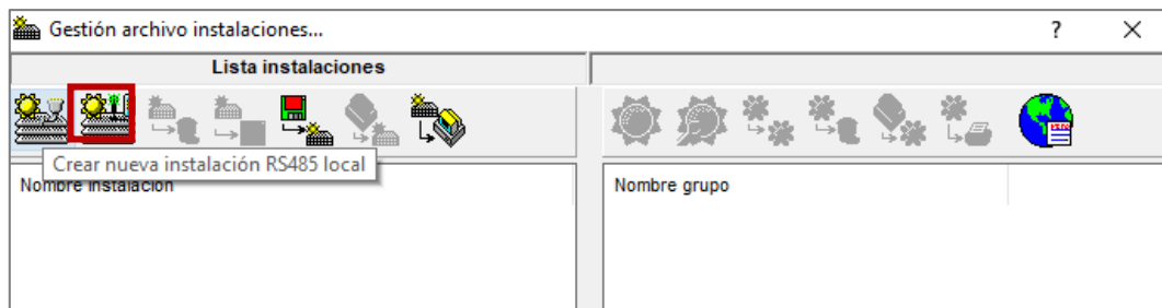
Figura 7: Ventana paso 4. Creación de nueva instalación (Configuración medidor parámetros GFV)
