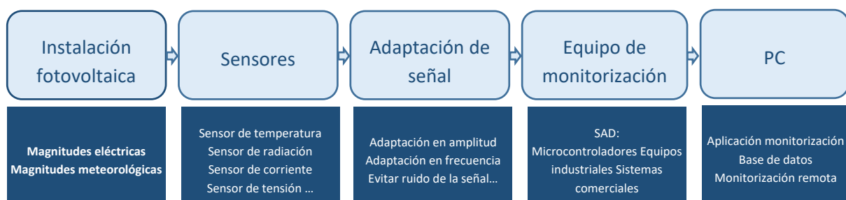
Figura 2.1: Arquitectura típica de sistema de monitorización
