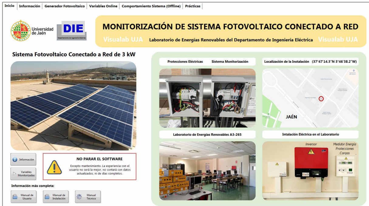
Figura 3.23: Pantalla 1(Inicio) de la aplicación de monitorización
