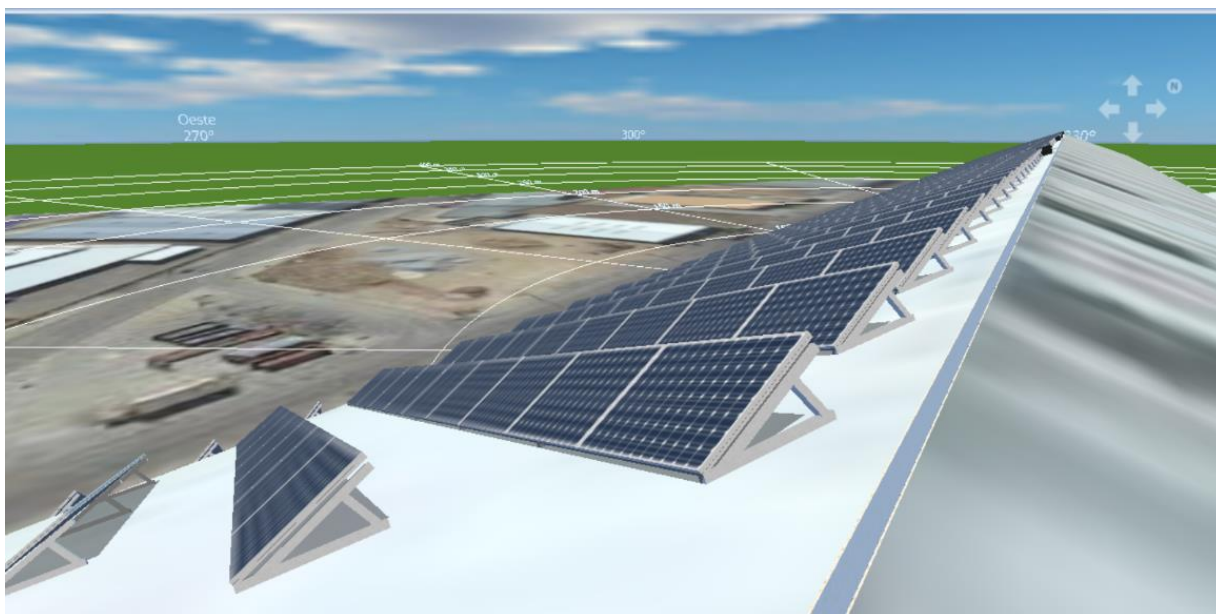
Ilustración 28. Representación en tres dimensiones de la distancia entre filas en la cubierta 1.
