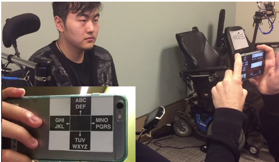
Figura 1: GazeSpeak siendo utilizada en un móvil con la pegatina y las letras
