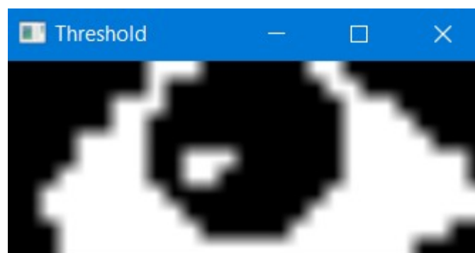
Figura 28: Ojo en blanco y negro tras aplicar thresholding
