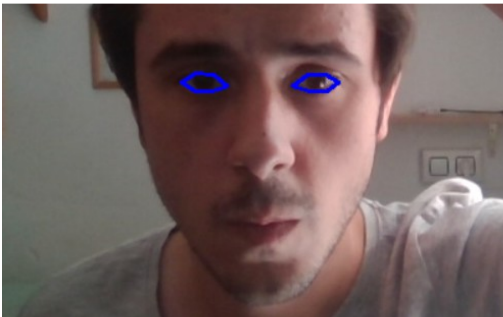
Figura 16: Dibujo de polígonos detectando la posición de ambos ojos.
