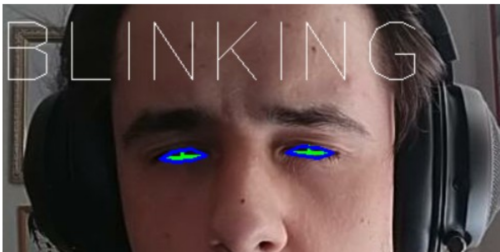
Figura 21: Detección del pestañeo al cerrar los ojos
