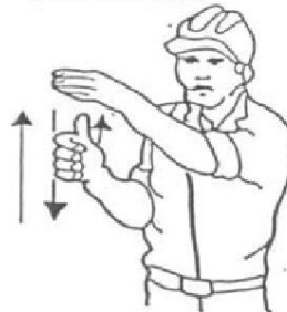
4 Levantar el aguilón o pluma lentamente
