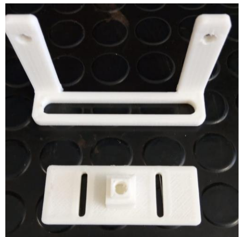
Ilustración 59: Soporte sensores fotoeléctricos
