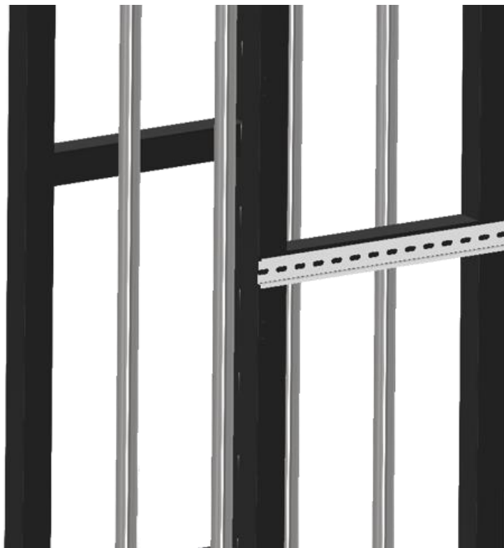
Ilustración 44: Montaje carril DIN
