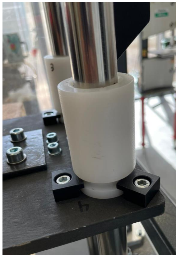
Ilustración 51: Montaje real casquillos de nylon
