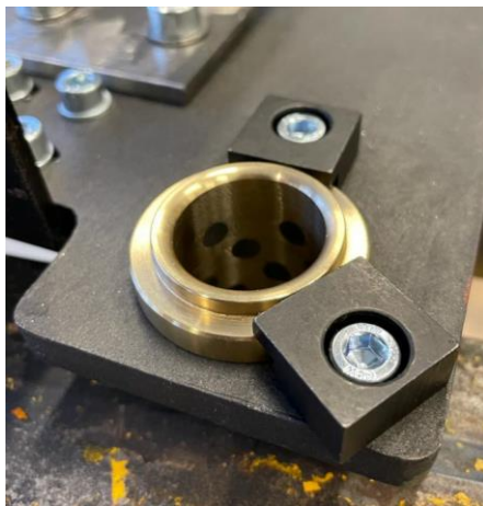
Ilustración 23: Montaje casquillos autolubricados
