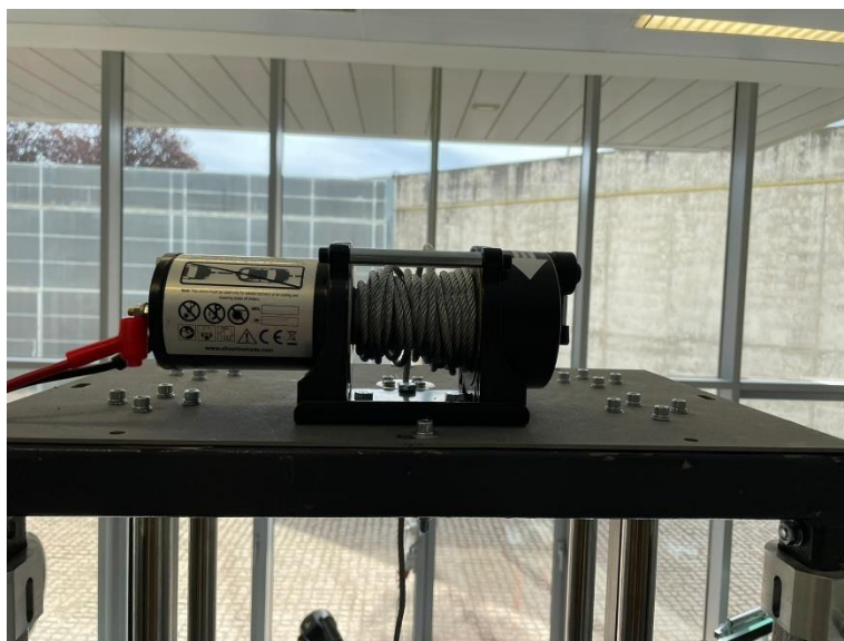
Ilustración 54: Montaje real placa superior con cabrestante
