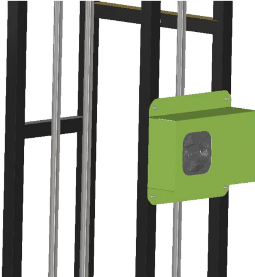
Ilustración 46: Montaje cubierta cajetín eléctrico
