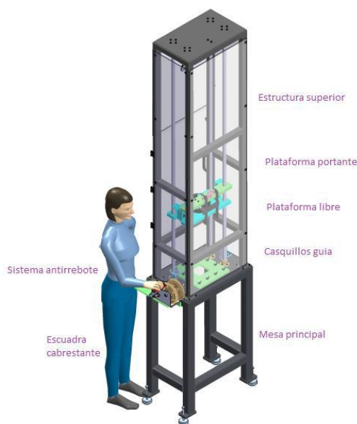
Ilustración 14: Diseño primario de la máquina [11]
