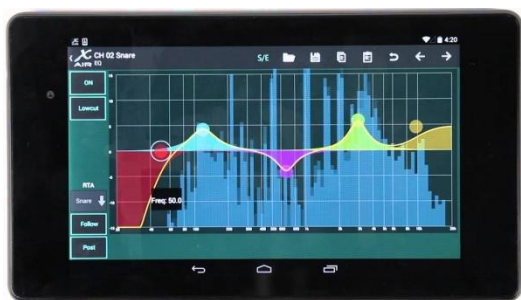
Ilustración 25: Espectro de frecuencia de una caja de batería desde el programa X-air de Behringer
