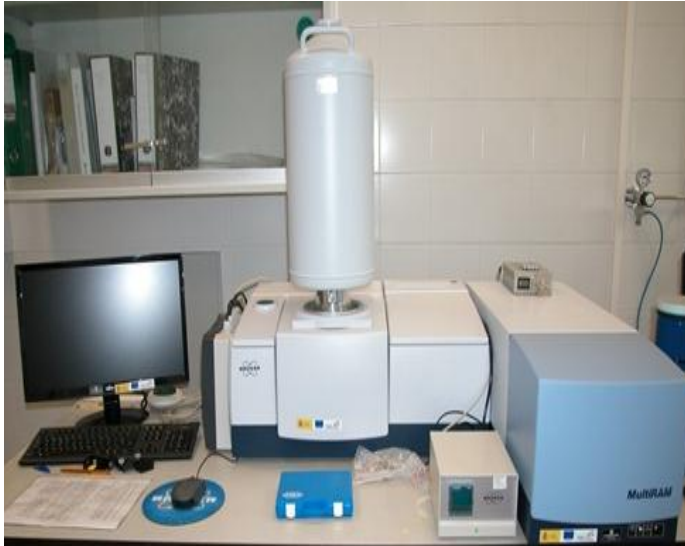
Ilustración 9: Espectrómetro FT-Raman (Catálogo de servicios y tarifas de Centro de Instrumentación Científico-Técnico de la Universidad de Jaén)
