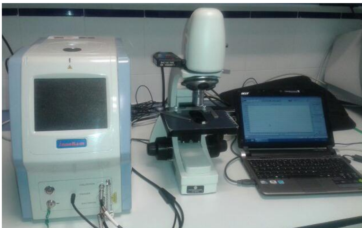
Ilustración 7: Microespectrómetro Raman dispersivo (Foto de Ignacio Olea Albar)
