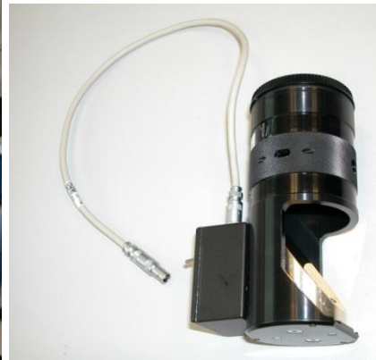
Ilustración 9: Espectrómetro FT-Raman (Catálogo de servicios y tarifas de Centro de Instrumentación Científico-Técnico de la Universidad de Jaén)
