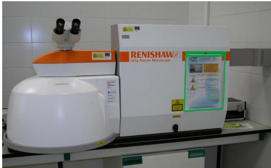
Ilustración 8: Microespectrómetro Raman confocal dispersivo (Catálogo de servicios y tarifas de Centro de Instrumentación Científico-Técnico de la Universidad de Jaén)
