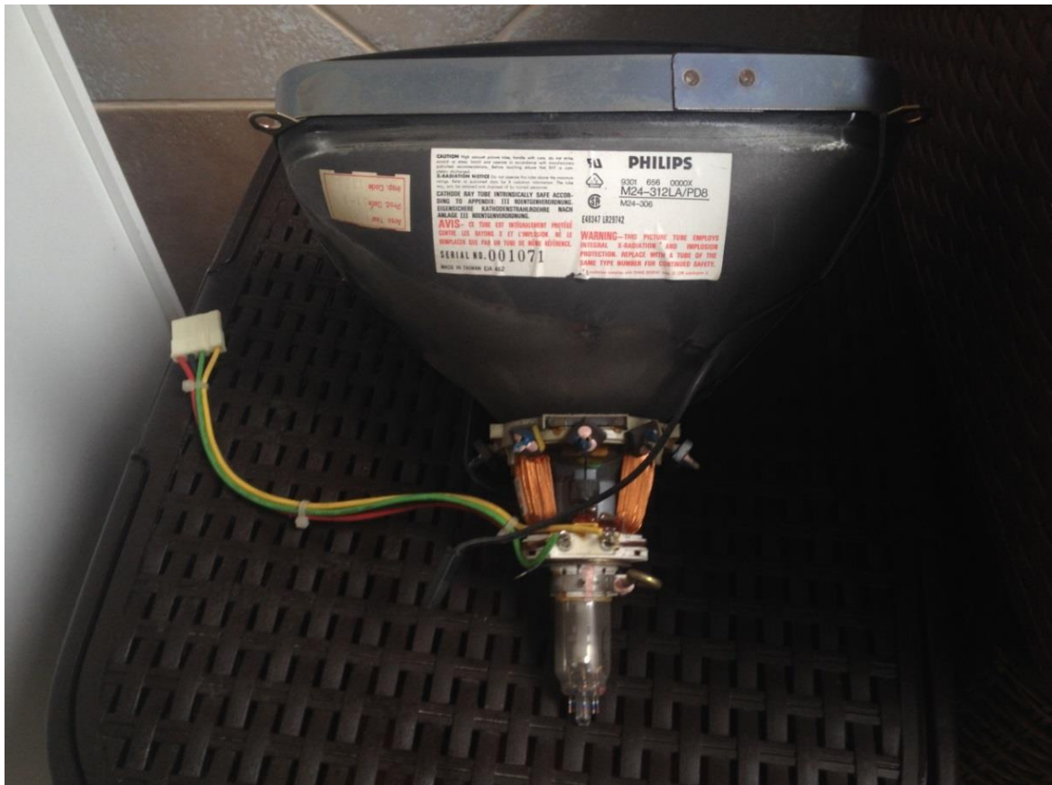
Figura 3.1: Tubo de rayos catódicos del osciloscopio
