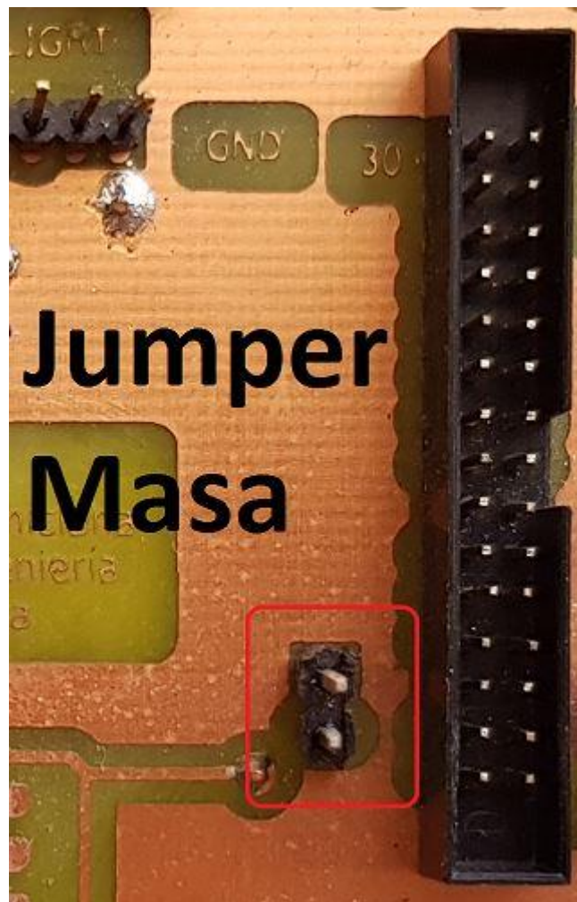
Figura 8.24: Jumper para poner el pin 4 a masa
