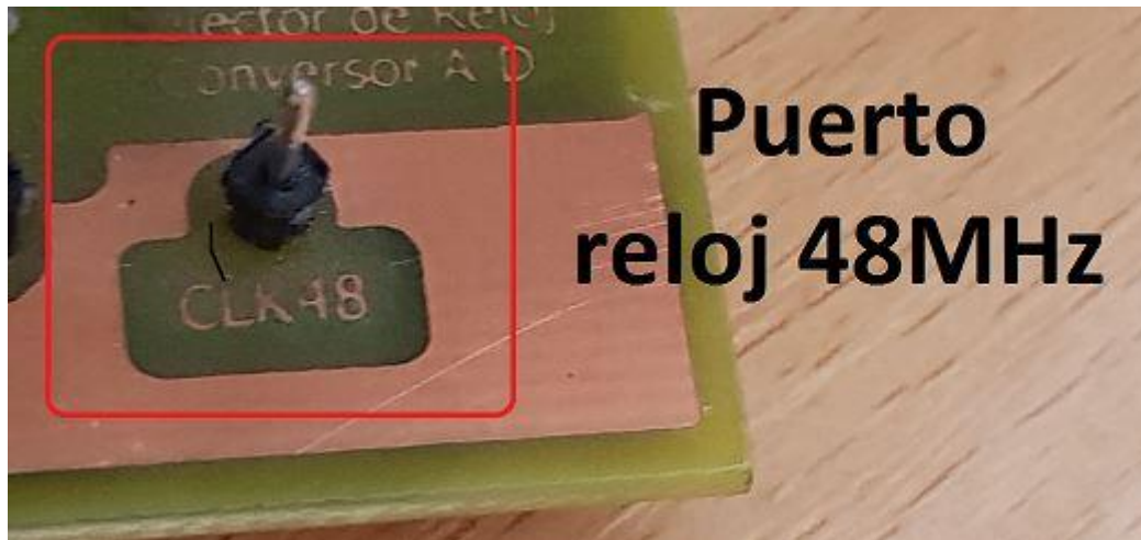
Figura 8.4: Puerto para las señal de reloj del osciloscopio
