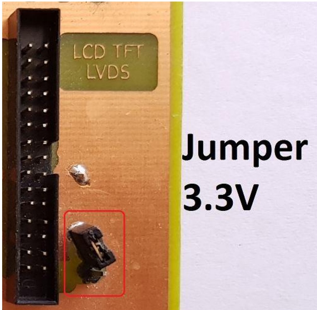
Figura 8.23: Jumper para poner el pin 3 a 3.3V
