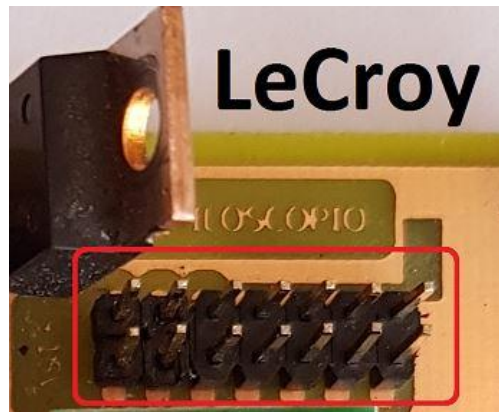
Figura 8.3: Puerto para las señales del osciloscopio
