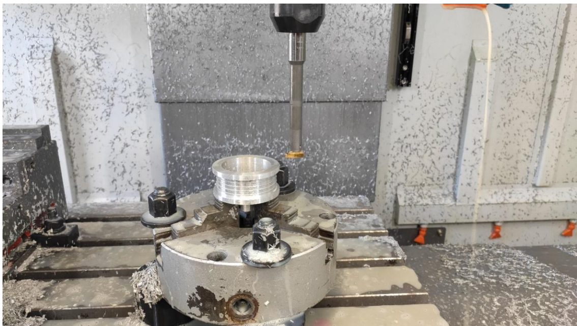
Figura 65. Mecanizado en CNC de la parte lateral.
