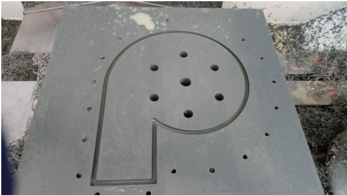
Figura 54. Mecanizado de la junta tórica y taladros pasantes.
