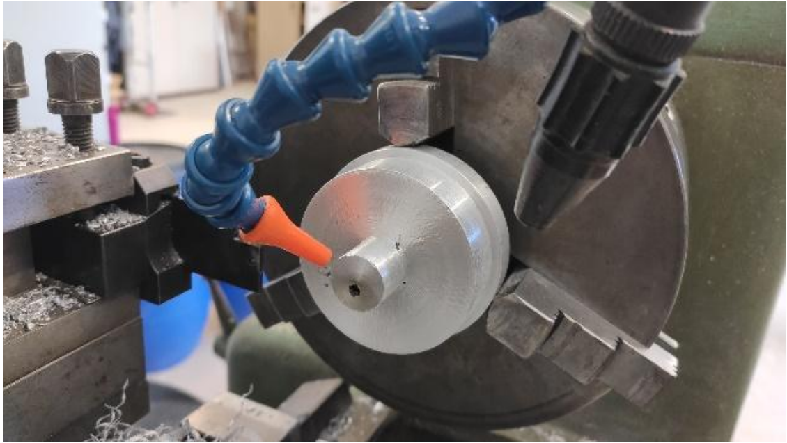
Figura 62. Eliminación de material hasta obtener el diámetro adecuado.
