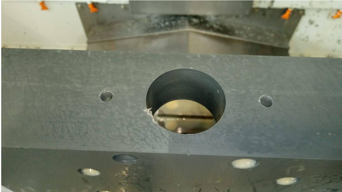
Figura 52. Mecanizado lateral de la entrada a la cámara espiral.
