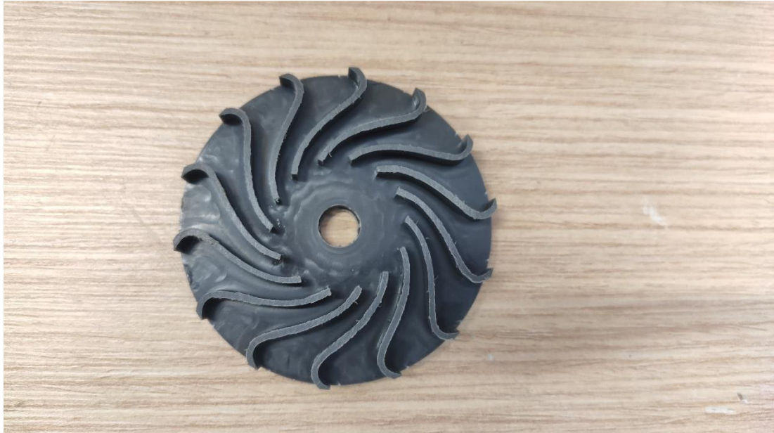
Figura 28. Rodete fabricado con el diseño del álabe calculado.
