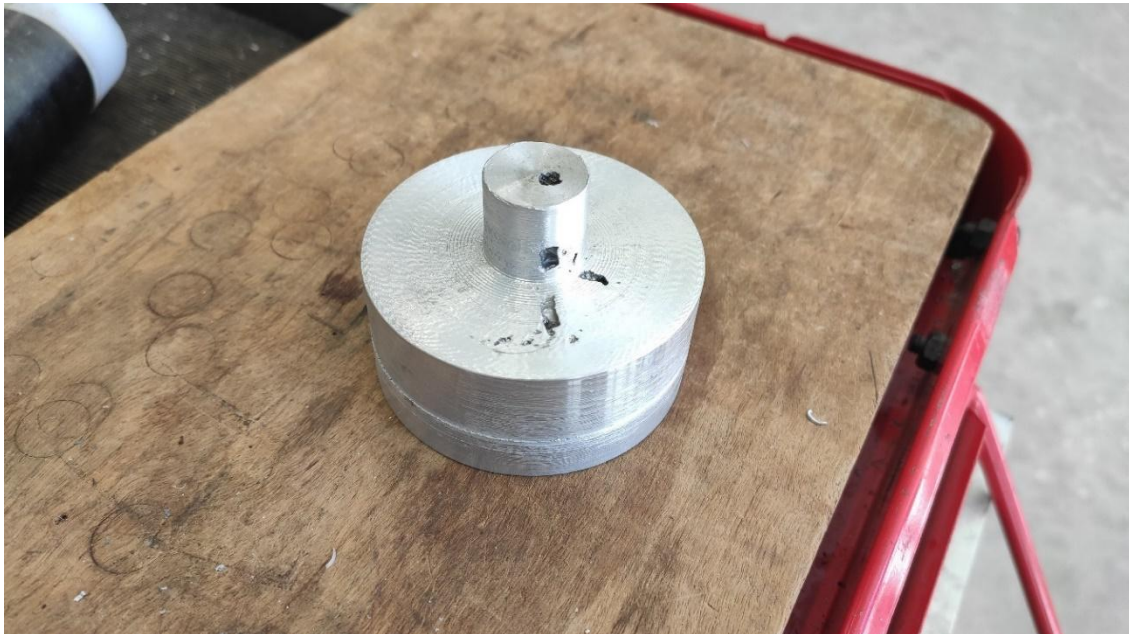
Figura 63. Pieza para introducir en CNC. Los poros que se aprecian son defectos encontrados en el material disponible.
