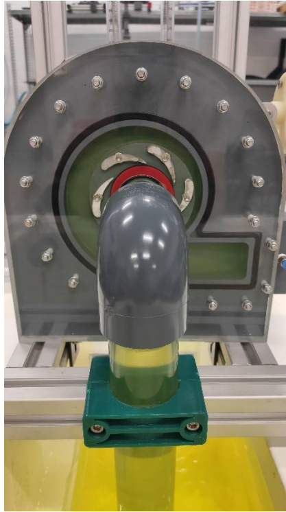
Figura 77. 100% apertura del distribuidor.
