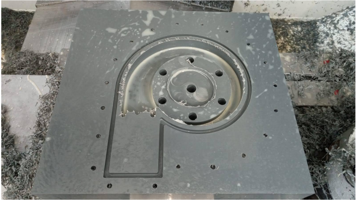
Figura 56. Mecanizado de la cámara espiral en CNC.
