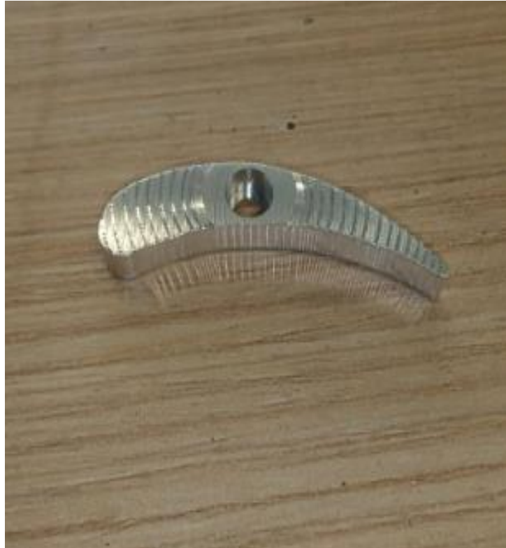
Figura 70. Álabes obtenido tras el proceso de fabricación.
