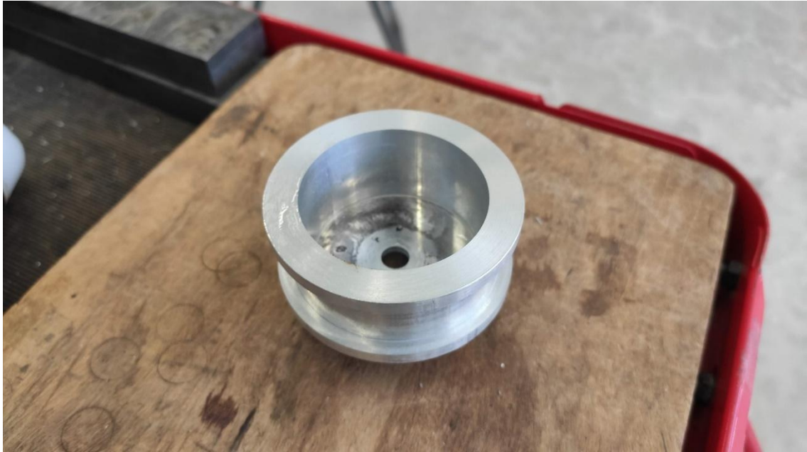
Figura 66. Polea de freno obtenida tras finalizar los procesos de fabricación.
