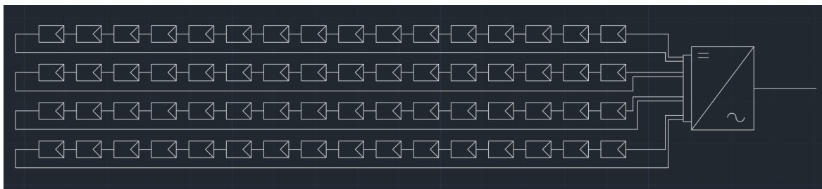
Ilustración 7. Conexión por strings módulos solares generador 20,41 kW
