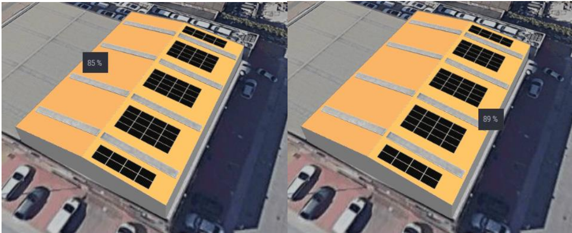
Ilustración 4. Porcentaje de irradiación recibida en cubierta
