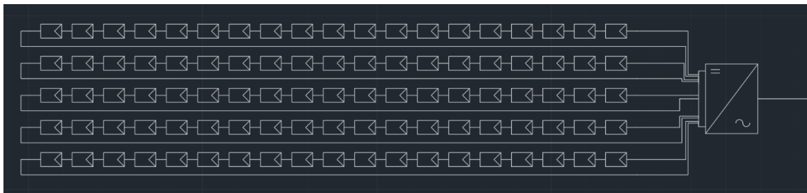
Ilustración 9. Conexión strings módulos solares generador 30,4 kW
